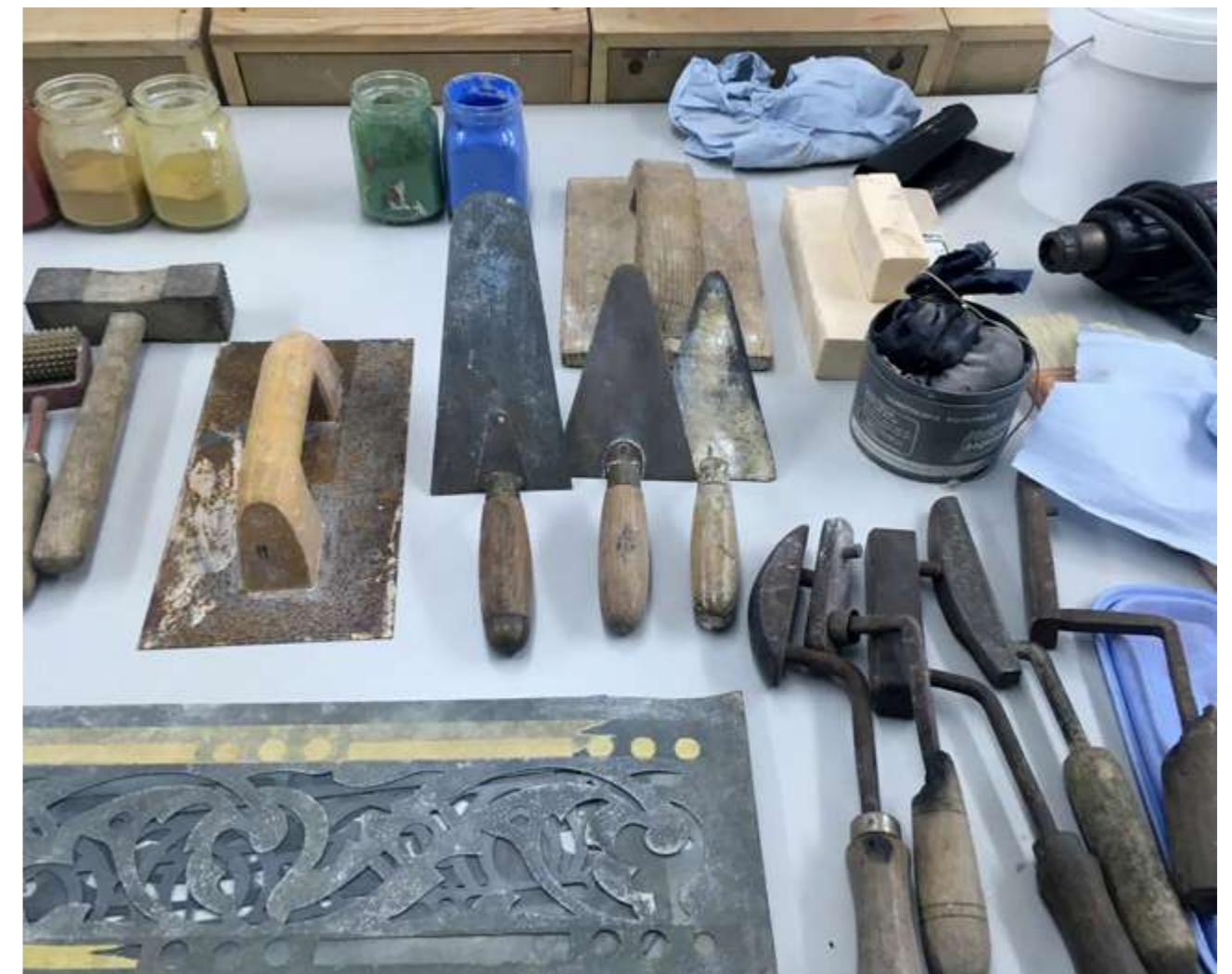
2. Herramientas para realizar estucos, en el taller de Oriol Garcia Alcocer
