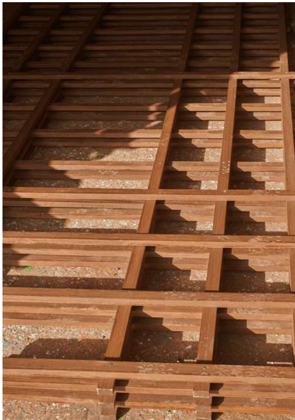
1. Construcción de las antenas de un molino harinero en el taller 2. Piezas recuperadas de molinos desaparecidos 3. Palas para un molino de extracción de agua
