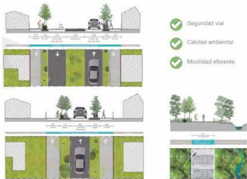
Figura 15. San José - Cantón Sucúa: Propuesta de secciones viales. Fuente y elaboración: Propia, 2018
