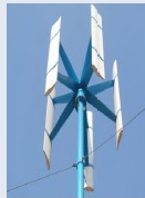
Axe de levage vertical (Darrieus)
