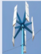
Eje vertical de sustentación (Darrieus)
