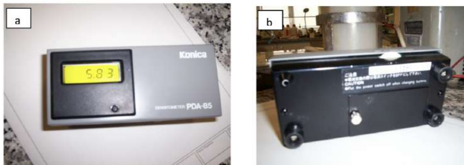
Figura 7.- (a) Vista anterior del densitómetro para su calibración o puesta a cero. (b) Vista posterior del densitómetro, donde se aprecia la zona de entrada de la luz en el apoyo superior izquierdo.
