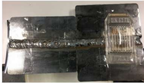
Figura 5.- Esquema de un indicador de calidad, e indicador de calidad colocado sobre una unión soldada.
