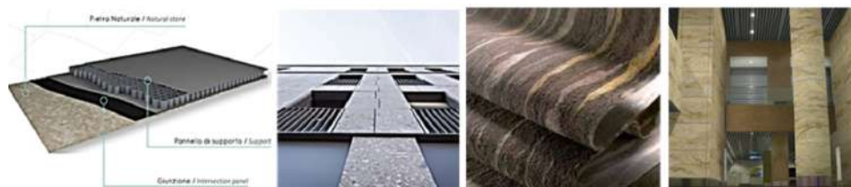
Figure 5. Stratificazione del pannello Petra Light; pellicola in pietra D-Layer.
