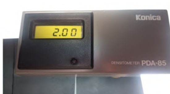
Figura 13.- Lectura de la densidad radiográfica en la unión soldada.
