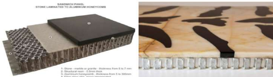
Figure 1. Stratificazione del pannello Petra Light della Remax; Pannello di marmo alleggerito NC Marmi.
