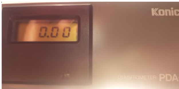
Figura 12.- Puesta a cero o calibración del densitómetro.
