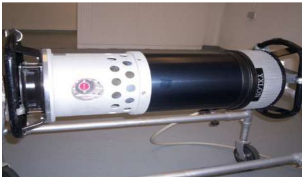
Figura 3.- Equipo de RX refrigerado por aire.
