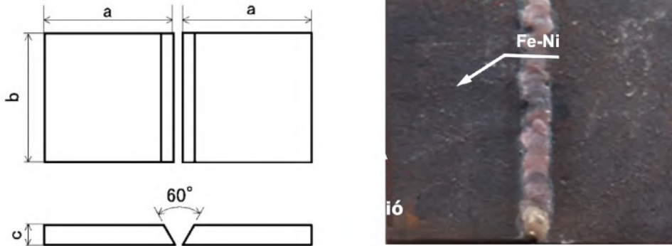
Figura 7. a) Preparación de probeta previo al soldado. b) Cupón soldado.
