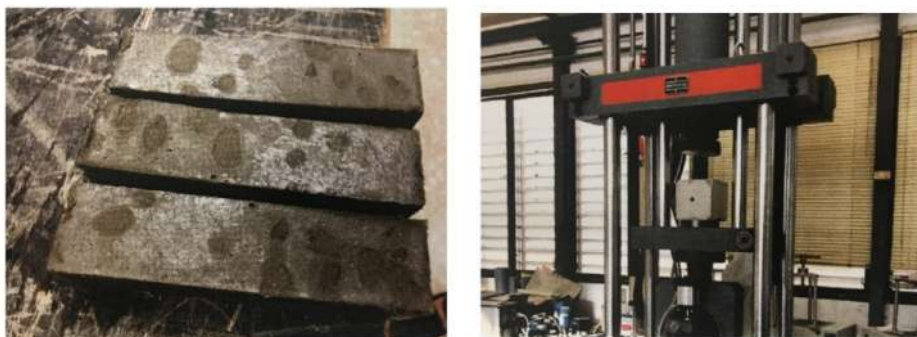
Figura 1. Probetas en estado no endurecido y máquina de ensayo.
