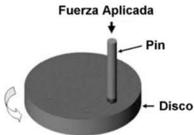
Figura 2. Esquema conceptual de un equipo pin-on-disk
