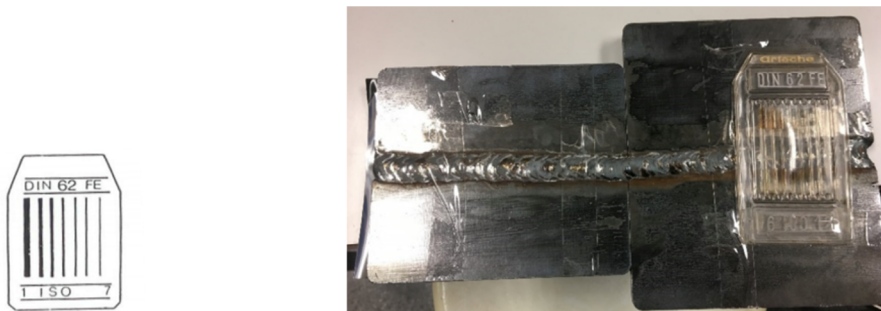
Figura 5. Esquema de un indicador de calidad, e indicador de calidad colocado sobre una unión soldada.
