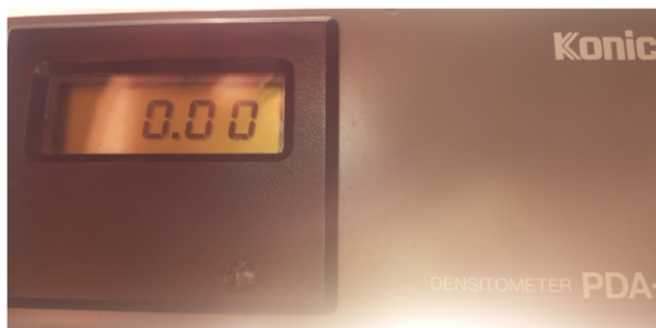
Figura 12. Puesta a cero o calibración del densitómetro.
