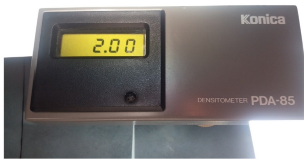
Figura 13. Lectura de la densidad radiográfica en la unión soldada.
