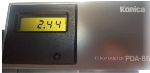
Figura 15.- Lectura de la densidad radiográfica en uno de los defectos de la unión soldada.
