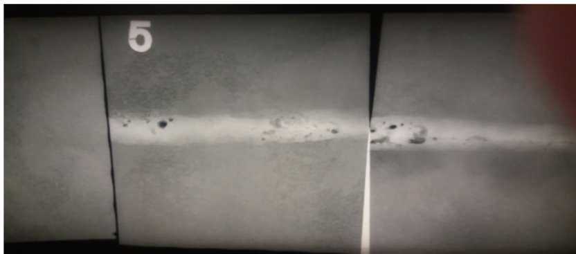
Figura 11. Radiografía obtenida en el examen radiográfico realizado sobre las muestras de la Figura 8.
