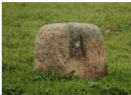
Contrapeso de prensa de tornillo.
