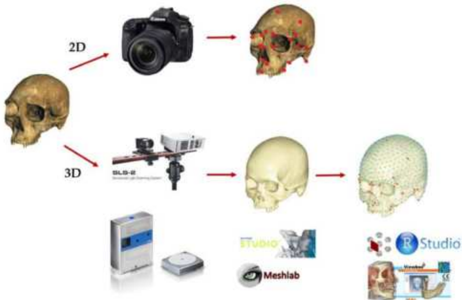
Figura 3. Metodología utilizada en la morfología geométrica. Arriba se muestra el procedimiento seguido en la morfometría geométrica en dos dimensiones (2D), que necesita de una cámara fotográfica que capture al objeto al que se le colocaran los landmarks mediante un programa de edición. Abajo se encuentra el procedimiento seguido en la morfometría geométrica en tres dimensiones (3D), que necesita de un escáner mediante el que se obtendrá un modelo digital en 3D. Con la ayuda de diversos programas informáticos se editará el modelo en 3D para eliminar los posibles artefactos que pueda tener y se colocarán los landmarks necesarios para el estudio. Imagen propia.
