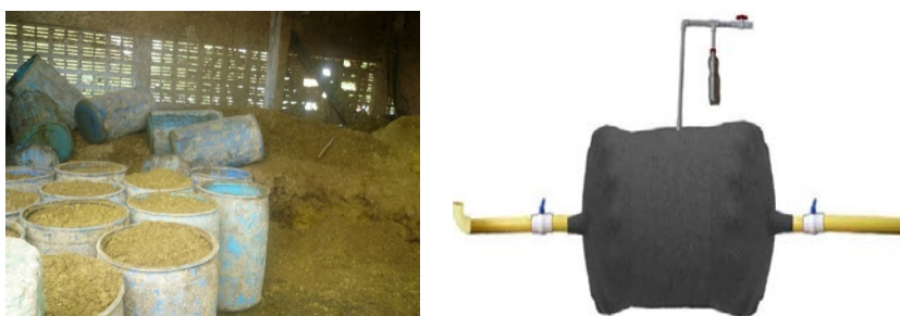
Figura 10. Canecas con material orgánico para llenado del digestor Friogan Villavicencio. Geomembrana para digestor parque Metropolitano María Lucia, disposición tubería entrada y salida de material organico en la geo membrana
