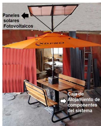
Figura 7. Ensamble de la estructura de soporte del sistema (quiosco)
