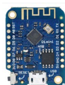
Figura 6. Tarjeta Embebida para IoT Wemos D1 mini
