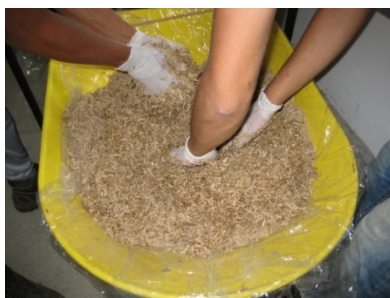
Figura 3. Mezclado de la madera de café triturada con las resinas y el catalizador
