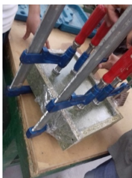
Figura 4. Formaleta utilizada para darle las dimensiones a los prototipos
