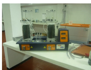
Figura 2. Biodigestor modelo W8 marca Armfield, laboratorio de hidráulica corporación Universitaria del Meta
