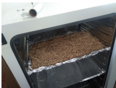
Figura 2. Madera triturada en el horno
