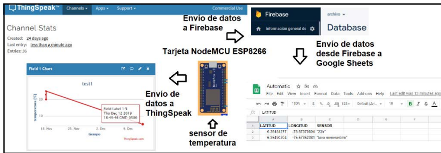
Figura 5. Esquema de comunicaciones y algunos resultados obtenidos en pruebas con sensor de temperatura
