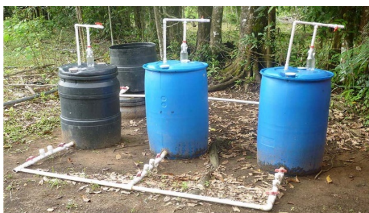
Figura 7. Prototipos de biodigestores con Bidones plasticos parque Metropolitano María Lucía
