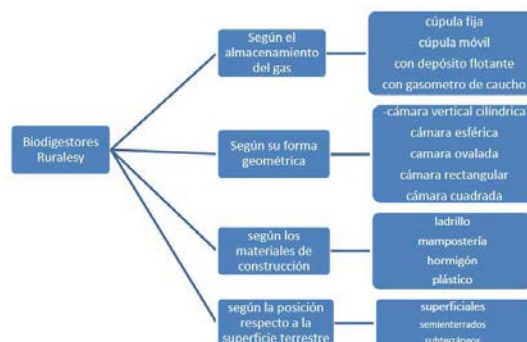
Figura 5. clasificación Biodigestores rurales [3]
