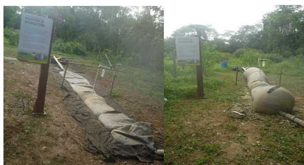
Figura 12. Digestor cargado al 70% de su capacidad. Biodigestor 2 meses despues, muestra la presencia de gas metano lo cual se visualiza en la expansión de la geomembrana
