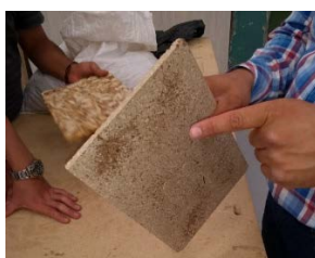
Figura 6. Prototipo con partículas entre 1cm y 1.5cm por 3mm de ancho
