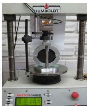
Figura 9. Ensayo de estabilidad y flujo Marshall
