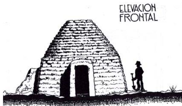
Figura 12. Elevación frontal de un Putuco (Levantamiento desarrollado a la vivienda del señor Paulo Chambi, por el Arq. Ferruccio Marussi Castellan, 1999)
