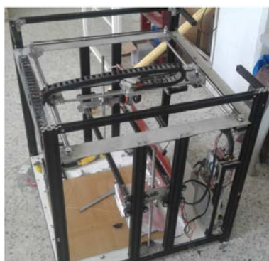
Figura 1. Impresora Pegasus Standard con sus tapas desmontadas
