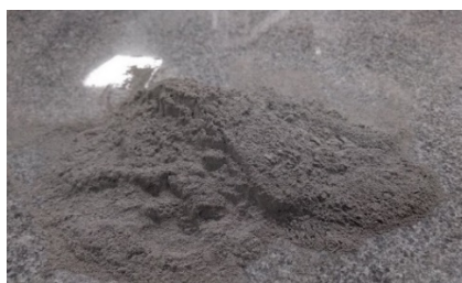
Figura 4. Polvo utilizado en la consolidación de ladrillos
