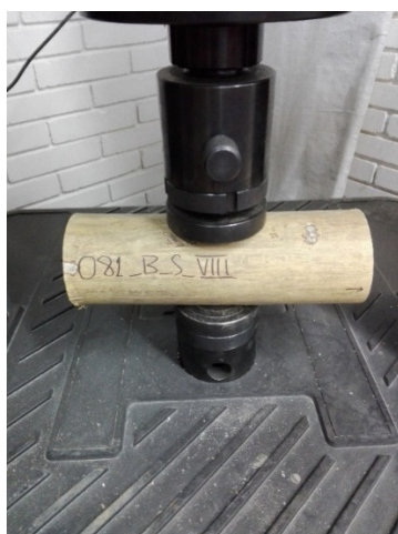
Figura 6. Ensayo a compresión perpendicular a la fibra, muestra de 10 cm de diámetro
