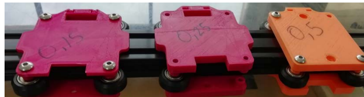
Figura 9. Tolerancia de los rodamientos tipo Derlin
