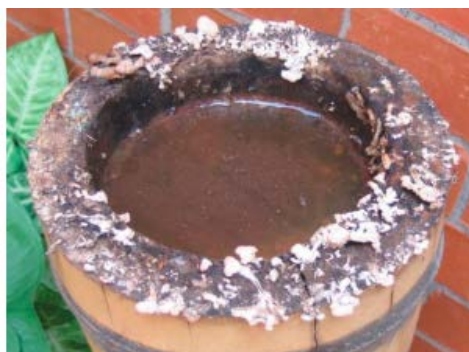
Figura 5. Guadua afectada por hongos
