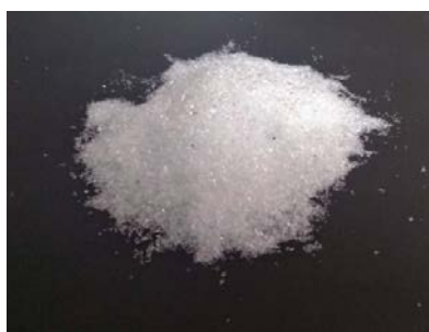
Figura 3. Polvo utilizado en la consolidación de ladrillos
