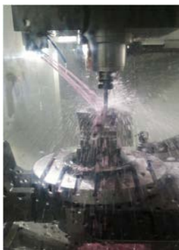
(a) Mecanizado de la unión en proceso con flujo continuo de refrigerante
