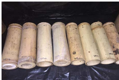
Figura 8. Culmos de guadua después de proceso de exposición a rayos UV
