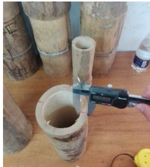
Figura 3. Medición de espesor de pared
