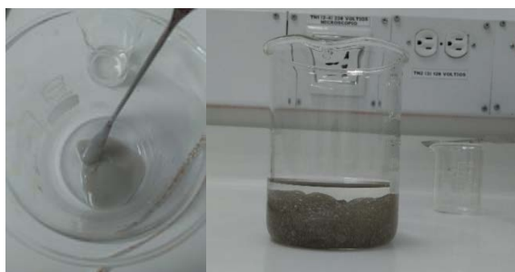
Figura. 6 mezcla EPS, Limoneno y etanol
