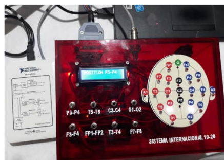
Figura 8. Caja prototipo, NI myDAQ y computador conectados
