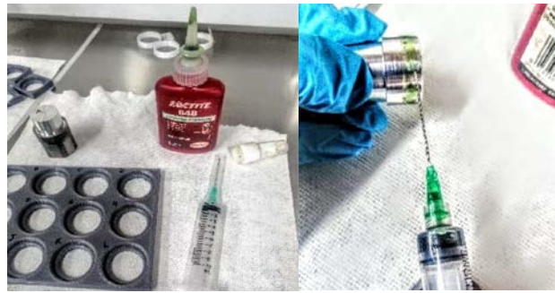
Figura 4. Aplicación del adhesivo Loctite 648 montaje de ensamble
