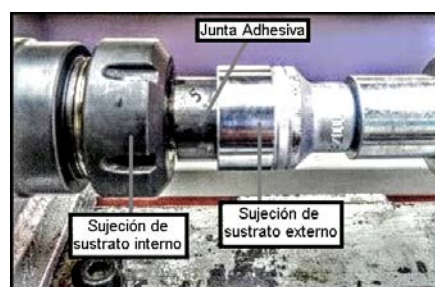
Figura 6. Montaje de la junta en banco de torsión
