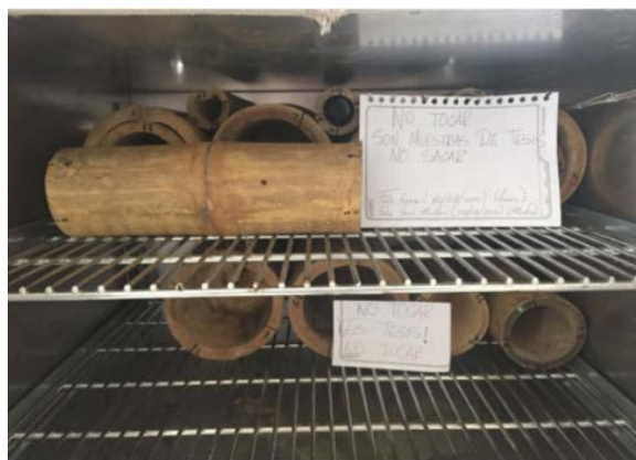
Figura 1. Probeta de guadua en estado verde puesto al horno
