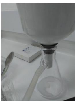
Figura 4. Filtración al vacío, mezcla de solventes
