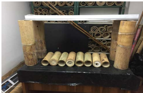
Figura 7. Montaje realizado para analizar culmos de guadua ante rayos UV
