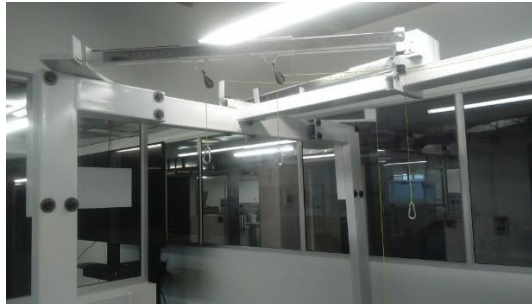
Figura 1736. Mecanismo de abducción/aducción con sistema de poleas
