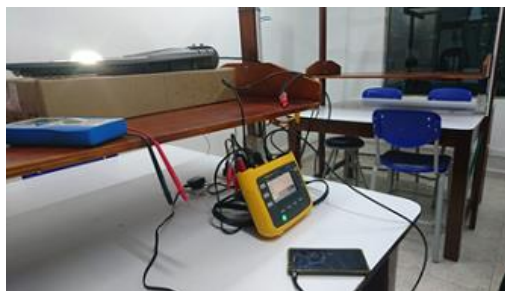
Figura 5. Foto del montaje para las mediciones THD de la luminaria led
