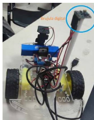
Figura 12. Ubicación de la brújula digital en el prototipo de robot 2WD
