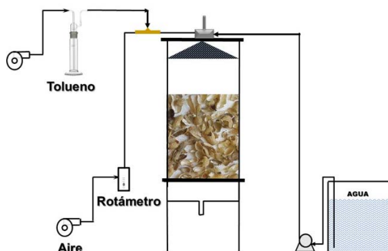
Figura 1. Biofiltro empacado con vaina de cacahuate para la degradación de metanol y tolueno
