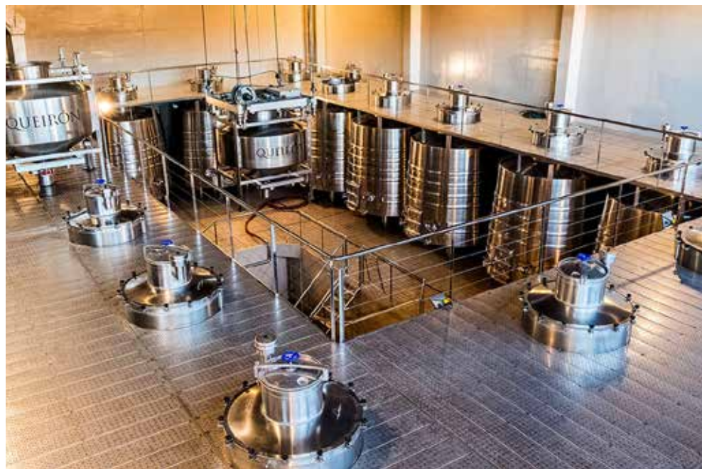
Nave de elaboración de Queirón, con el sistema de gravedad adaptado al siglo XXI, con los depósitos, las comportas y el torco.
