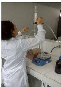
Figura 4. Aparato extractor liquido-líquido
