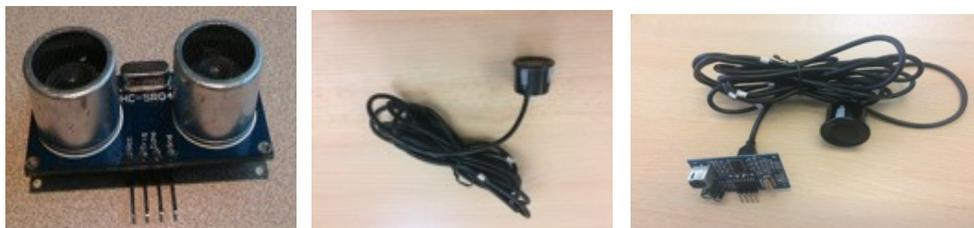
**Figura 1.** Sensor HC-SR04, Transductor ultrasónico, Sensor JSN-B02
