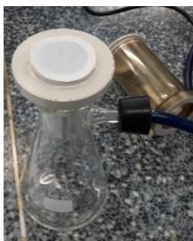
**Figura 2.** Membrana *MARTIN* ubicada en el sistema de filtración al vacío
