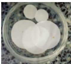
**Figura 1.** Fragmentos de membrana *MARTIN*, diámetro de 4,5cm
