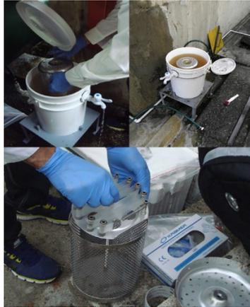
**Figura 4.** Despliegue de muestreadores pasivos en plantas de tratamiento
