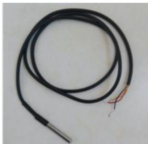
**Figura 5.** Sensor de temperatura DS18B20
