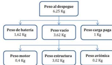
Figura 5. Clasificación de pesos de la aeronave ADAS-X2
