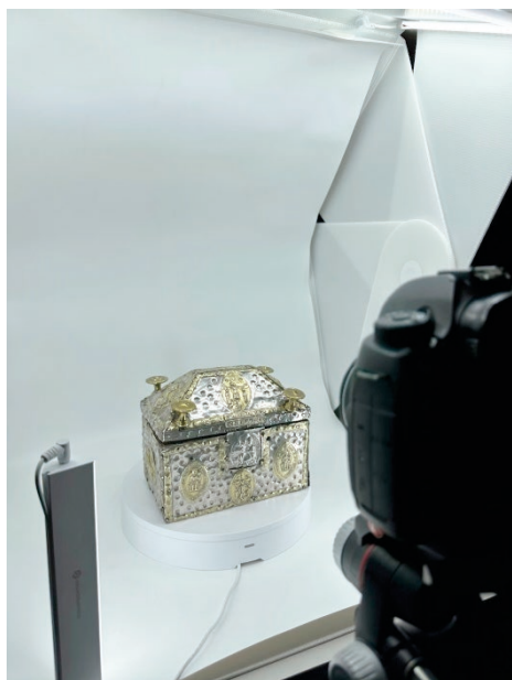
Fig. 3. Proceso de documentación fotogramétrica motorizado y automatizado en una campaña de virtualización de 2022 para el Gobierno vasco.
