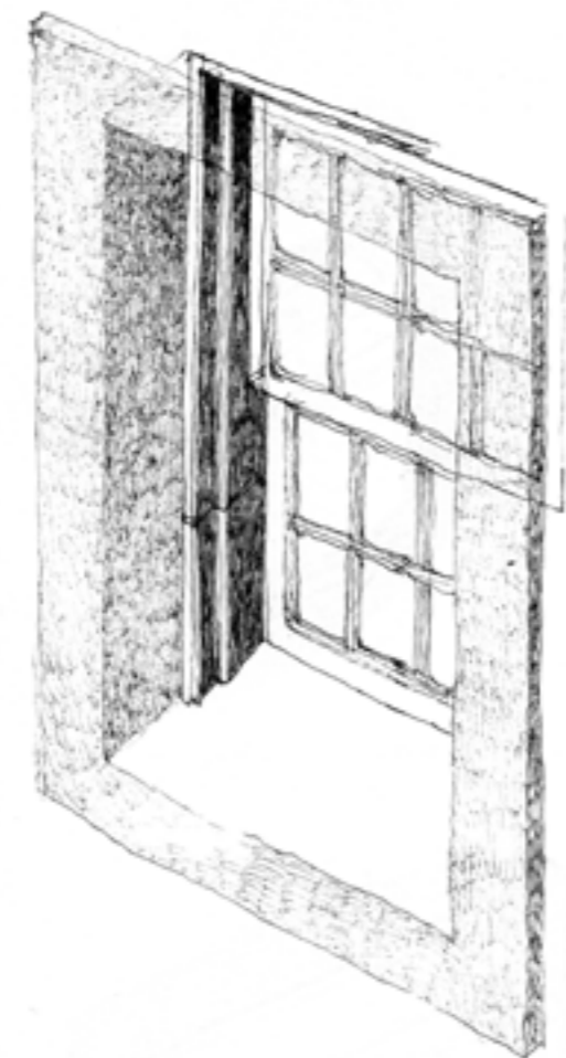
Construction details of traditional openings on the island of Pico | Detalhes de construção de aberturas tradicionais na ilha do Pico | Detalles constructivos de ventanas tradicionales de la isla de Pico (Alejandro Martínez del Río).
