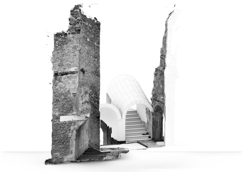
**FIGURAS 11.1 y 11.2. Análisis geométrico y restitución de la bóveda oblicua y escalones del segundo tramo a partir de los datos obtenidos del modelo fotogramétrico, sombreado en color gris la parte de la estructura que aún está en pie (imagen superior). Reconstrucción 3D de la parte de la bóveda desaparecida, escalones y parte del muro lateral, representados en color blanco, superpuestos sobre el modelo fotogramétrico de la ruina (imagen inferior).**
