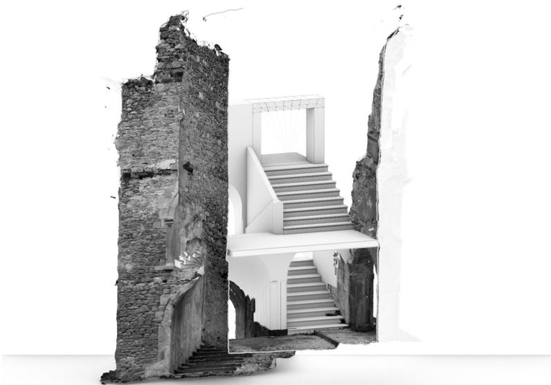
**FIGURAS 13.1 y 13.2. Restitución del arco adintelado y escalones del cuarto tramo sin referencia a estructuras existentes (imagen superior). Reconstrucción 3D del hueco de paso, escalones, rellano y pasamanos, representados en color blanco, superpuestos sobre el modelo fotogramétrico de la ruina (imagen inferior).**
