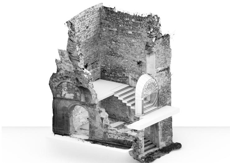
FIGURAS 12.1 y 12.2. Análisis geométrico y restitución del arco de medio punto oblicuo y escalones del tercer tramo a partir de los datos obtenidos del modelo fotogramétrico, sombreado en color gris la parte de la estructura que aún está en pie (imagen superior). Reconstrucción 3D de la parte de la bóveda desaparecida, escalones y rellano, representados en color blanco, superpuestos sobre el modelo fotogramétrico de la ruina (imagen inferior).
