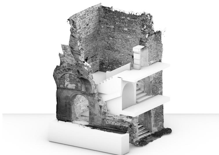
**FIGURAS 14.1 y 14.2. Análisis geométrico y restitución del balcón con arco adintelado a partir de los datos obtenidos del modelo fotogramétrico, sombreado en color gris la parte de la estructura que aún está en pie (imagen superior). Reconstrucción 3D de la parte desaparecida, representada en color blanco, superpuesta sobre el modelo fotogramétrico de la ruina (imagen inferior).**
