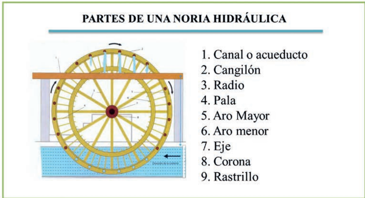
Figura 3. Partes de una noria. (Molina y Navarro, 2004)
