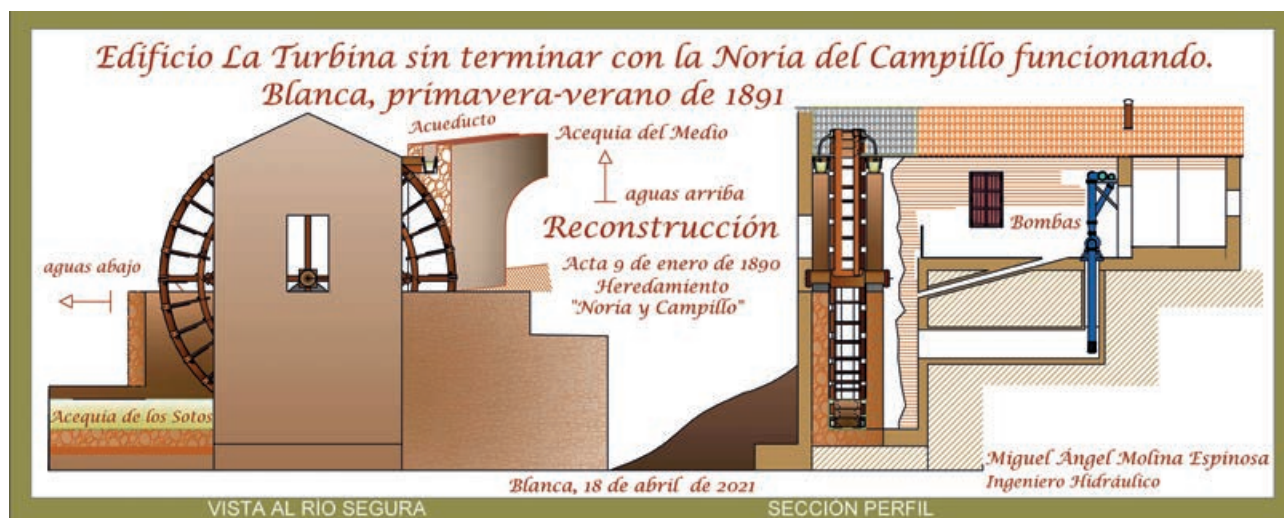
Figura 7. Construcción de la sala de La Turbina con la Noria del Campillo en su interior. (Autor: Miguel Ángel Molina Espinosa, 2021)
