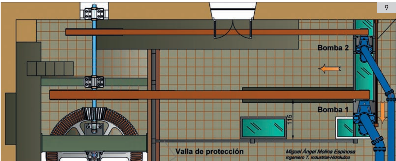
Figura 8. Techo de caña en la parte de la noria y distinto techo de madera en el resto de nave. Detalle de la cabeza del pilar de una de las canales de recogida del agua elevada por la noria. (Autor: José Raúl Gómez Sánchez, 2011) / Figura 9. Disposición de bombas y correas de transmisión. Plano parcial. (Autor: Miguel Ángel Molina Espinosa, 2019)
