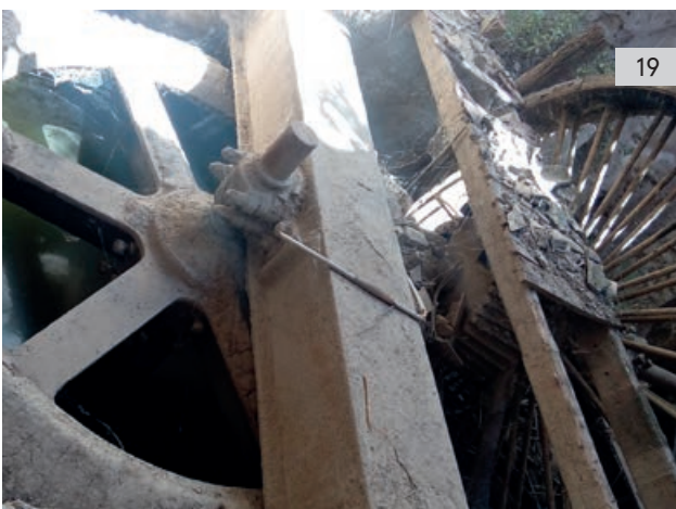
Figura 19. Trasmisiones de La Turbina en estado de abandono. (Autor: Miguel Ángel Molina Espinosa, 2019) / Figura 20. Reconstrucción de los transmisores. (Autor: Miguel Ángel Molina Espinosa, 2020)
