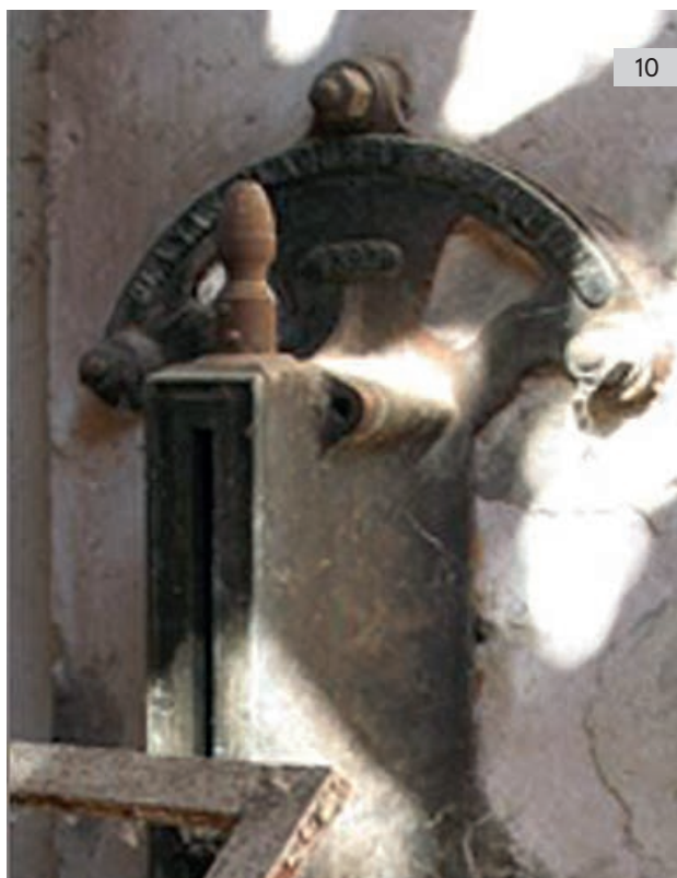
Figura 10. Mecanismo de medición de apertura y cierre de los cueros. Grabado en fundición: Planas, Flaguer y Cia. Gerona 1892. Elemento desaparecido. (Autor: Miguel Ángel Molina Espinosa, 2003) / Figura 11. Mapa de las instalaciones de Planas, Flaguer y Cia. en España. (Autor: Nadal Oller, 1992, p. 88)
