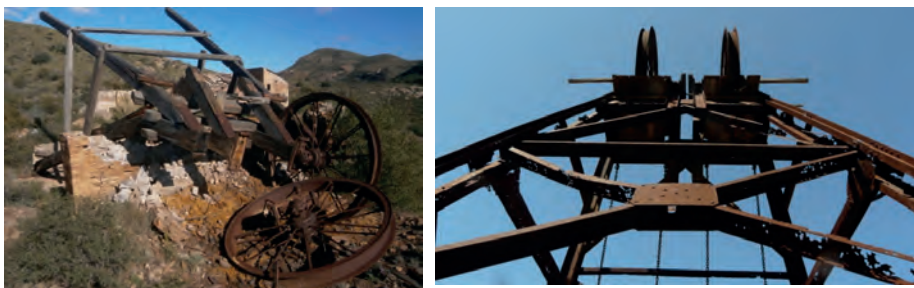
Figura 3. Castillete de madera caído, mina Observación a Santelvas (El Gorguel), y castillete metálico de mina La Pagana (Llano del Beal).
