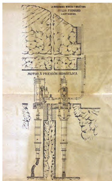
Imagen 3. Hidromotor instalado por Julio Frigard. Patente nº 17549. AHOEPM.
