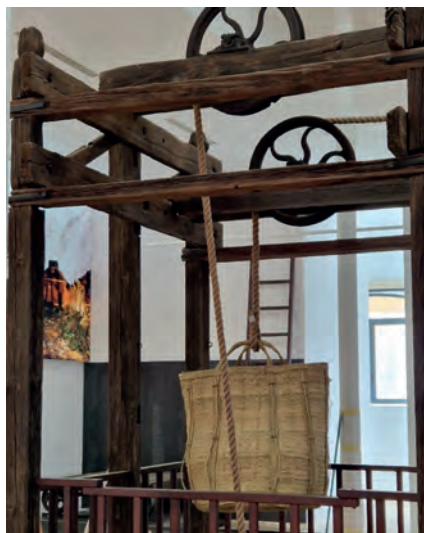
Figuras 15. Imagen del proceso de elaboración artesanal del esportón (réplica). Figura 16. Imagen donde se observa la colocación del esportón en el extremo de una de las cuerdas del malacate. Fotografías: Sonia Hernández Gómez.
