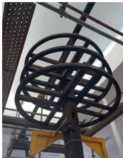
Figuras 11. Imagen de montaje del castillete en el interior del Museo Mínero. Fotografías: Sonia Hernández Gómez. Figura 12. Imagen de detalle de la estructura del tambor del malacate durante las labores de montaje. Fotografía realizada por Sonia Hernández Gómez.
