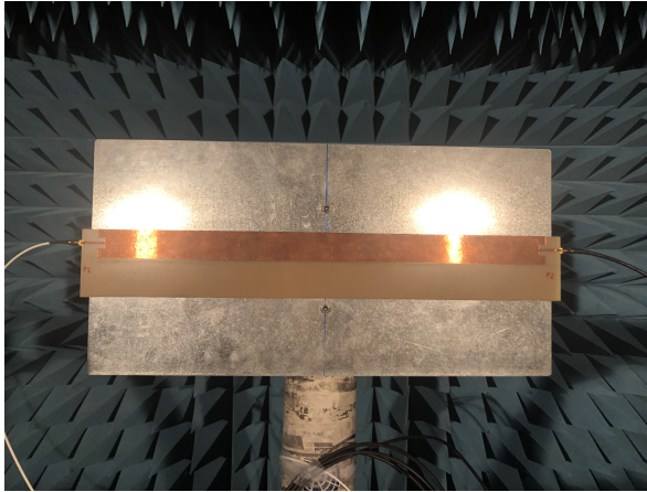
Figura 3.1: Antena hecha a mano por los estudiantes.
