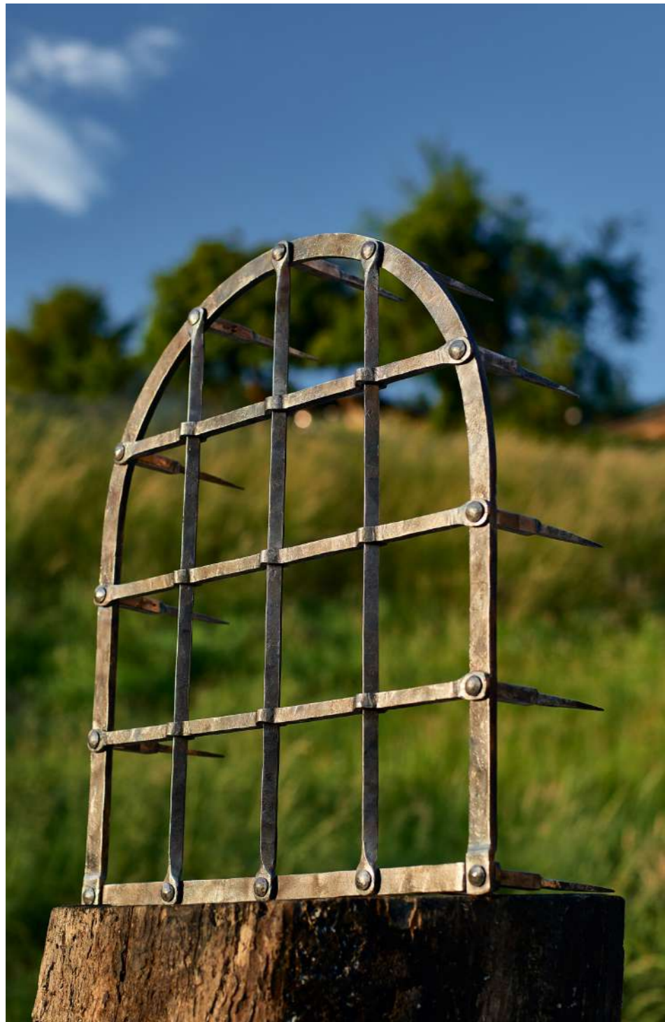
Reja elaborada con técnicas de forja tradicional
