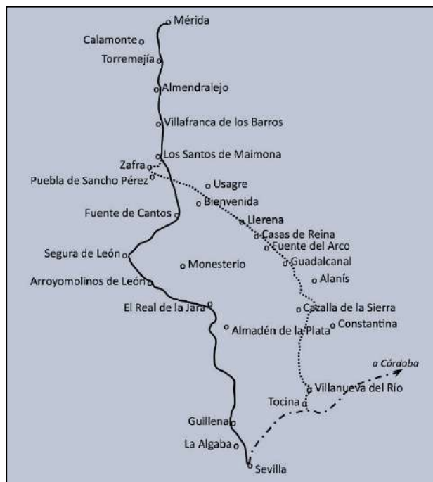
Fig. 1: Proyecto de Roberto Kith para el ferrocarril de Mérida a Sevilla, pasando por Fuente de Cantos. El trazado de puntos es el que finalmente seguiría la línea.
