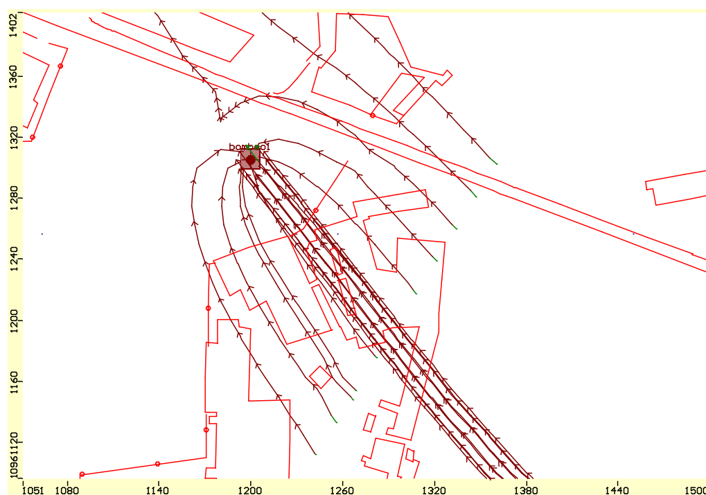
Figura VI.5. Trayectorias de las partículas para el segundo escenario, caudal de bombeo 500 m 3 /día (cada una de las marcas de la trayectoria de las partículas equivale a 5 días).
