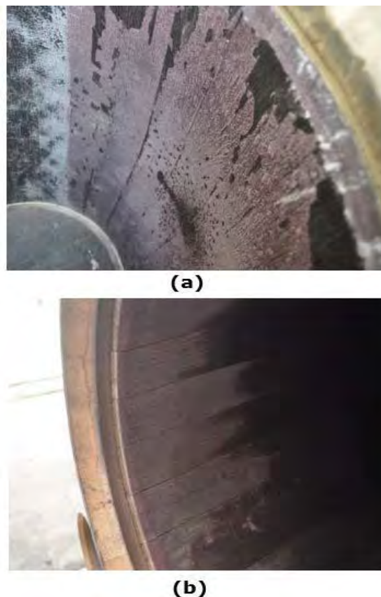
Figura 50: Eliminación de cristales de tartrato en una barrica tras la proyección de carbono supercrítico (a) antes del tratamiento (b) tras el tratamiento
