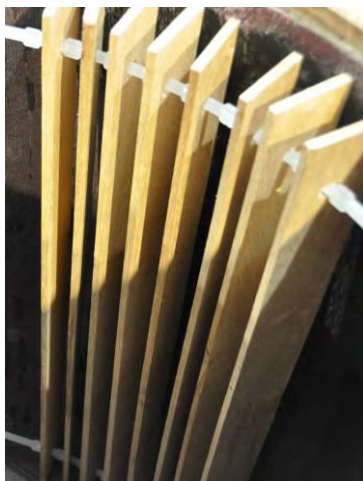
Figura 60. Sistema de sujeción de listones diseñado para su uso en barricas agotadas.
