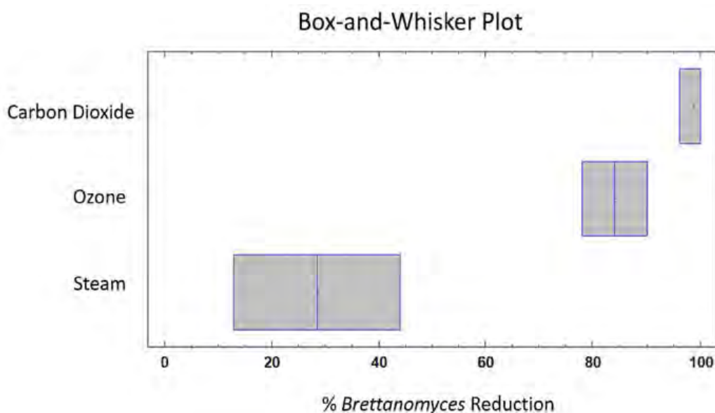
Figura 48: Diagrama Box-and-Whisker que muestra reducción porcentual de presencia de Brettanomyces (%) para cada uno de los tratamientos aplicados
