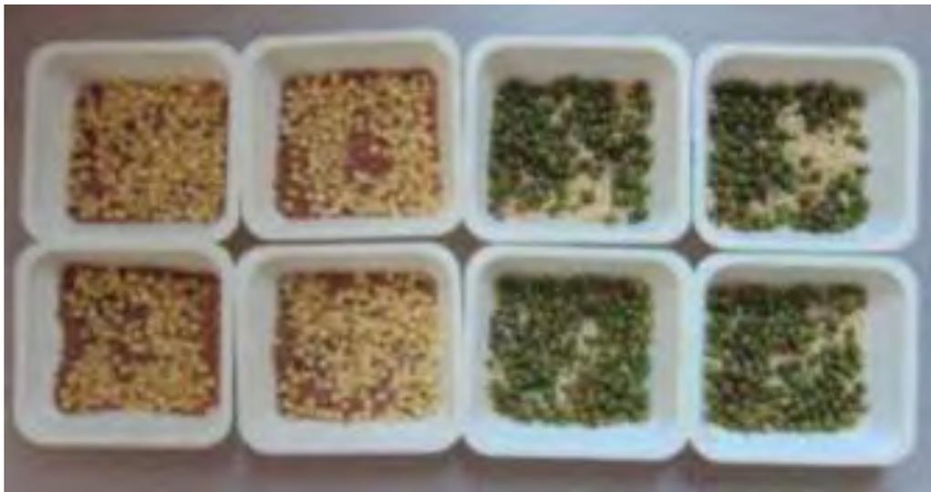
*Figura 39. Fracciones de mezcla binaria empleadas para el llenado de la tolva,; izda sémola de trigo, dcha soja y mijo.*
