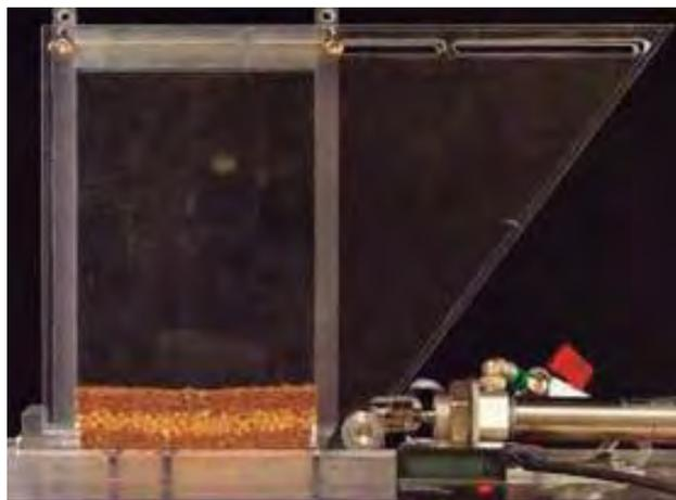
Figura 88 .Situación inicial en el ensayo 2D Vertical. Llenado 4 capas. Sémola – Sémola
