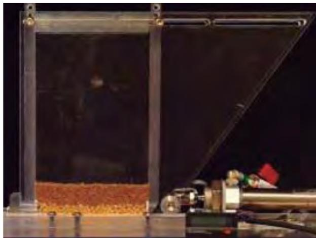
Figura 83 .Situación inicial en el ensayo 2D Horizontal. Llenado 4 capas. Sémola – Sémola.
