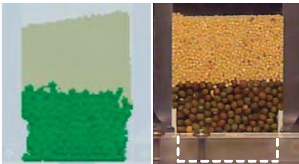
Figura 94. Simulación 2D Vertical 90 2 Capas. Sémola Soja. Estado inicial.
