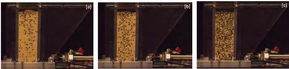
*Figura 51. Situación inicial del carro alimentador en el ensayo Sémola-Soja 2D-Vertical 25/75 Industrial (a), 2D-Vertical 50/50 Industrial (b) y 2D-Vertical 75/25 Industrial (c).*
