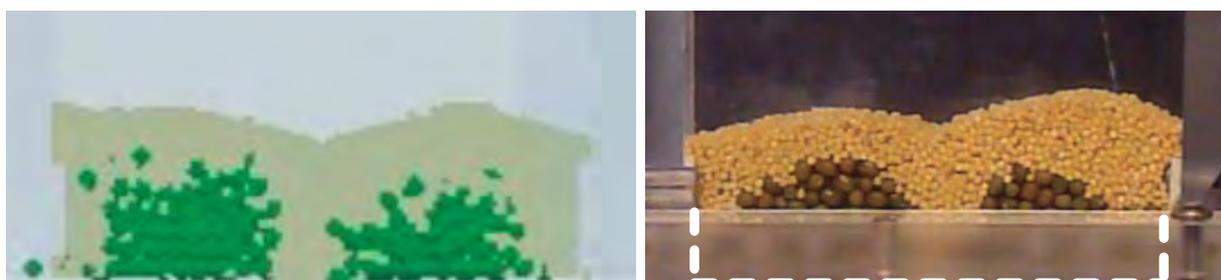
Figura 104. Simulación 2D Horizontal 90 2 Capas. Sémola Soja. Muestra 3.
