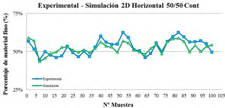
Figura 128. Comparativa de resultados entre la simulación en EDEM y las pruebas experimentales. 2D Horizontal 50/50. Llenado continuo. Sémola-Sémola.
