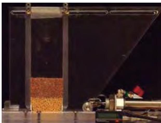
*Figura 72. Situación inicial en el ensayo 2D Vertical. Llenado 2 capas. Sémola – Sémola.*
