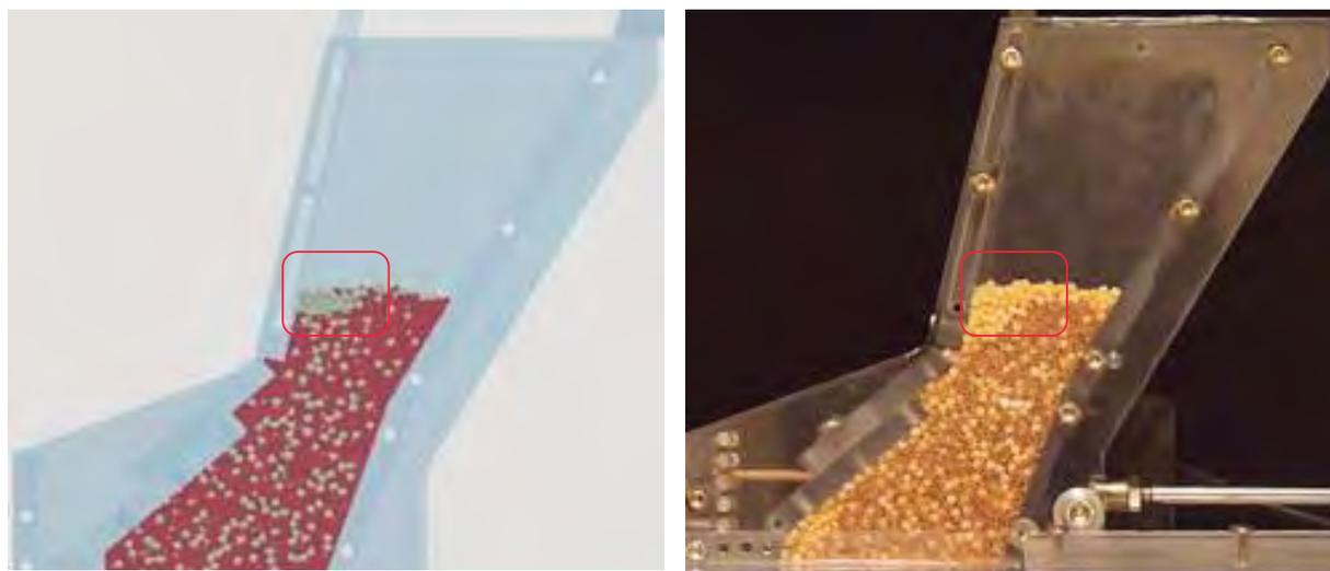
Figura 137. Comparativa de resultados entre la simulación en EDEM y las pruebas experimentales. Muestra 13.
