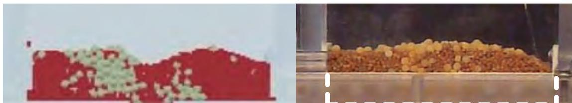
*Figura 87. Simulación 2D Horizontal 90 2 Capas. Sémola Sémola. Muestra 6.*
