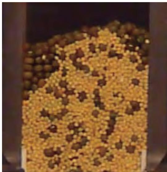
Figura 120. Efecto nueces de Brasil en el comprimido 17 de la prueba real 2D Vertical 25/75. Sémola-Soja.
