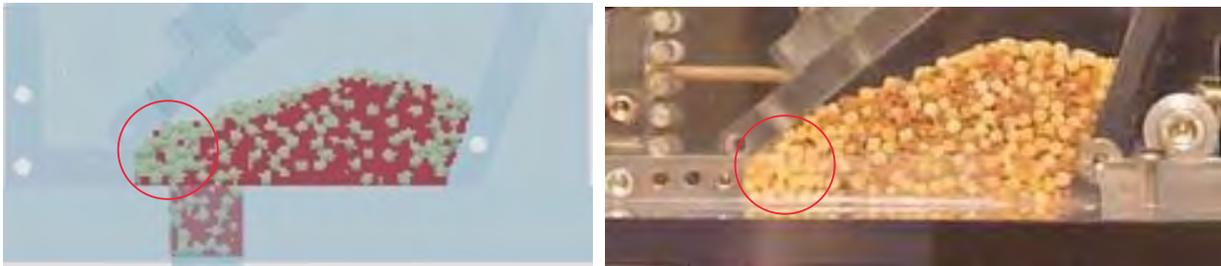
Figura 135. Comparativa de resultados entre la simulación en EDEM y las pruebas experimentales. Muestra 24.
