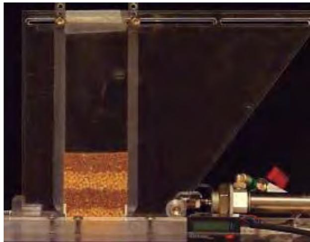
*Figura 78 .Situación inicial en el ensayo 2D Vertical. Llenado 4 capas. Sémola – Sémola.*
