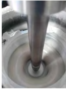
Figura 151. Imagen del sistema de agitación Dispermat® con formación de un vórtice la agitación.
