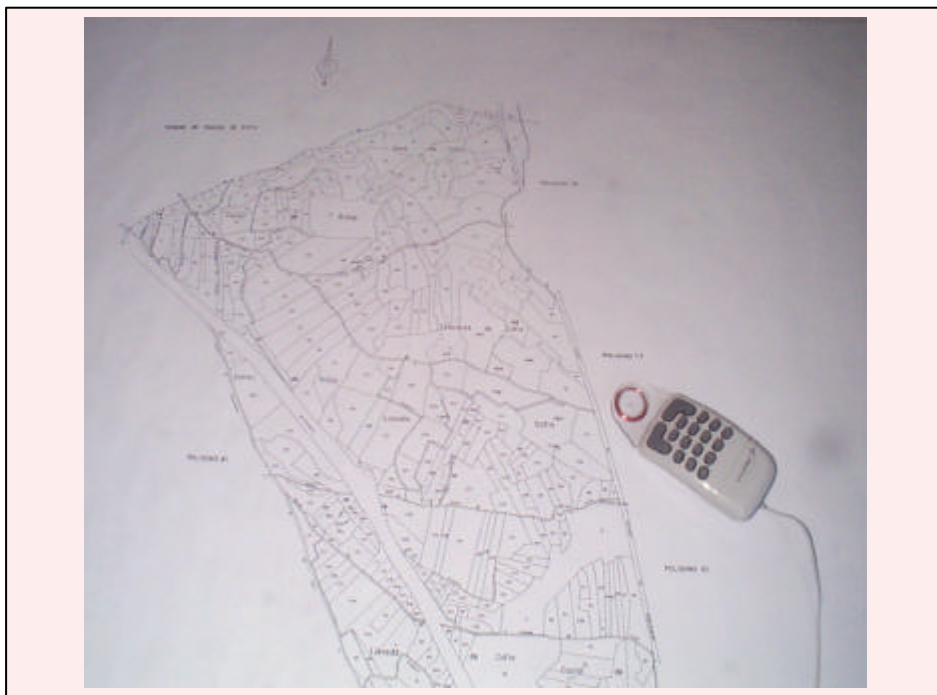
Fig. 6.27 - Digitalización de planos catastrales sobre mesa digitalizadora.
