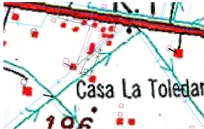
Fig. 2-2. Ejemplo de error de posición en dos dimensiones en cartografía. En la figura se representan superpuestas dos cartografías a escala 1/25000 y 1/50000. Los vectores indican la diferencia entre las posiciones de algunos elementos comunes en ambas cartografías. Esta diferencia de posición implica una distancia y una dirección y sentido que habitualmente se obvia en el tratamiento del error.
