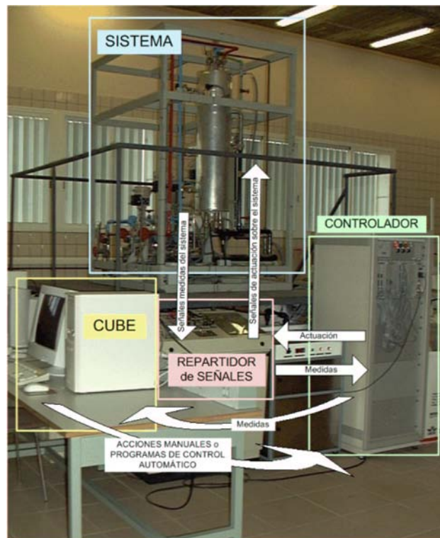
Figura 5.2: Equipos del laboratorio empleados para el control de la temperatura del agua de salida de un intercambiador de calor.
