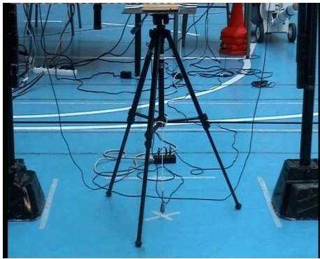
Figura 3.13. Conexión de las 3 placas presensibles a la caja de conexiones, ubicada en el suelo y detrás del trípode.
