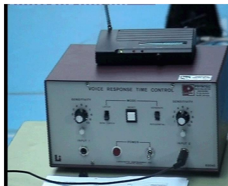
Figura 3.10. Sistema interruptor por sonido, Lafayette 63040*C, empleado para el registro del momento temporal de contacto con la pelota, tanto en laboratorio como en pista de tenis.
