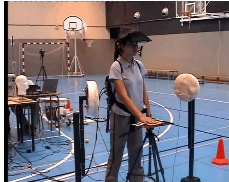
Figura 3.8. Sujeto experimental preparado en situación real de juego con el dispositivo estructural de registro de la respuesta de reacción.
