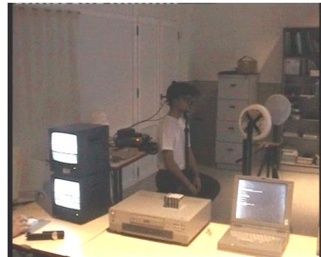
Figura 3.6. Soporte de video digital utilizado para el registro del comportamiento visual durante un ensayo de la secuencia en laboratorio.
