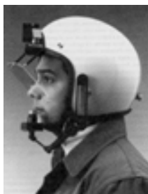
Figura A.14: Existen varios sistemas de seguimiento ocular, para reconocer la dirección de la mirada, los cuales se están empleando, por ejemplo, como interfaces de comunicación sustitutivos portátiles, con aquellas personas que no pueden mover sus brazos o piernas. Un ejemplo de ellos es el seguidor ocular de los Laboratorios Applied Science, provisto de una cámara en la frente, que registra los ojos a través del espejo translúcido. La cámara que se ve en la barbilla, es opcional, y se encargaría de registrar lo visto por el usuario, para su análisis posterior. — Fuente: JACOB [1569] (p. 1506).
