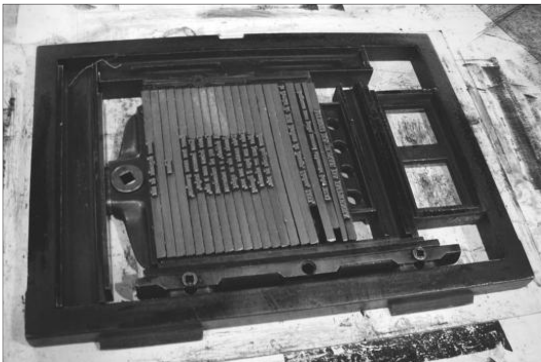
Fig. 6.12 Forma tipográfica o molde, con el texto dispuesto en líneas, lista para ser colocada en la prensa
