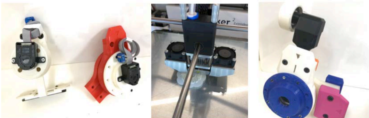
Figura 4.13. En la zona izquierda se representan las exo-articulaciones del tobillo, rodilla y cadera fabricadas y ensambladas. En la parte derecha, una pieza durante el proceso de fabricación aditiva.
