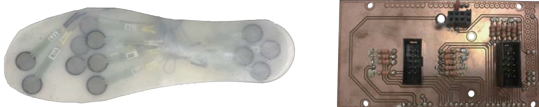
Figura 4.46. Conjunto de suela sensitiva y escudo de conexiones que actúa como interfaz entre los sensores y la placa desarrolladora Arduino® .
