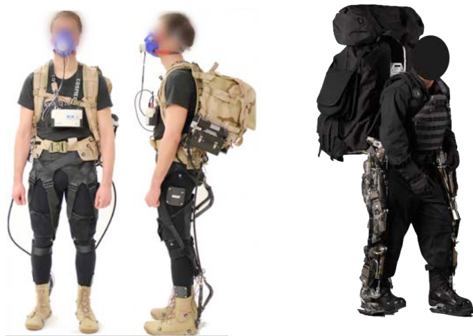
Figura 2.4. A la izquierda el Exosuit flexible [39] y a la derecha el exoesqueleto R1-BLEEX [34]
