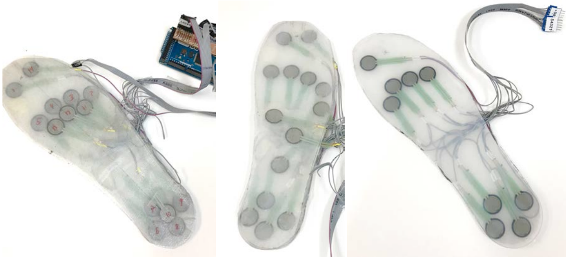
Figura 4.31. Suelas sensitivas con diferentes configuraciones de la posición y cantidad de los sensores de presión.
