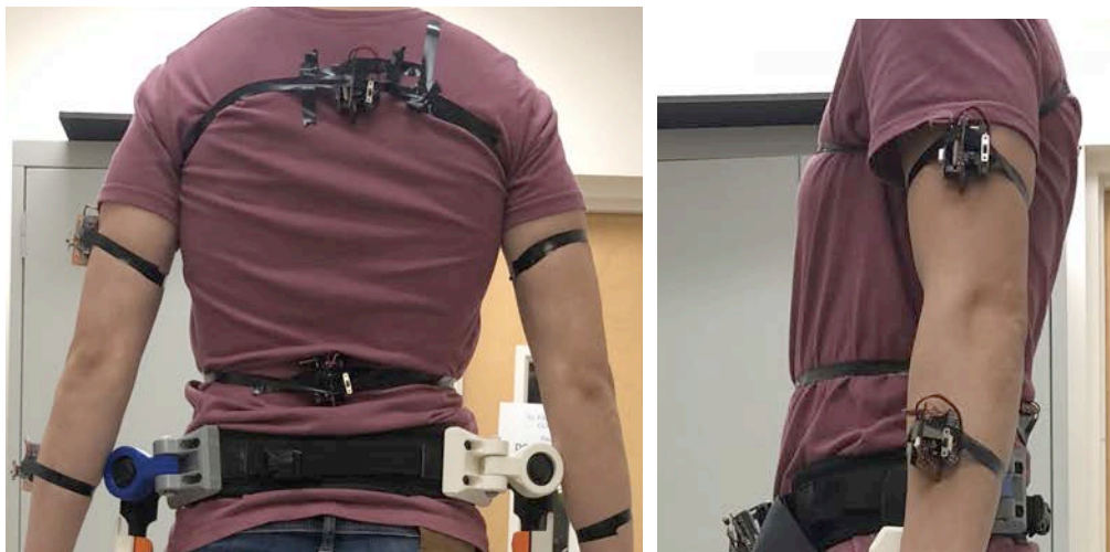
Figura 4.21. Posición de las seis (6) unidades inerciales en la zona superior del cuerpo.
