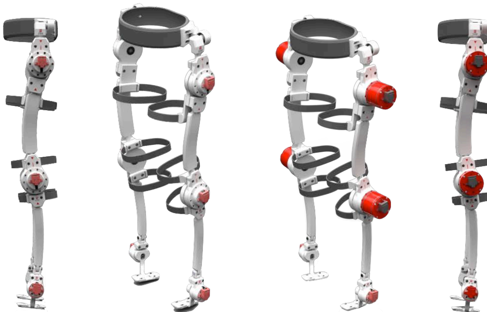
Figura 4.4. A la izquierda, el exoesqueleto en la fase funcional 1 (iDAS/WIMDA). En la parte izquierda la fase funcional 2 (Asistencia al movimiento)
