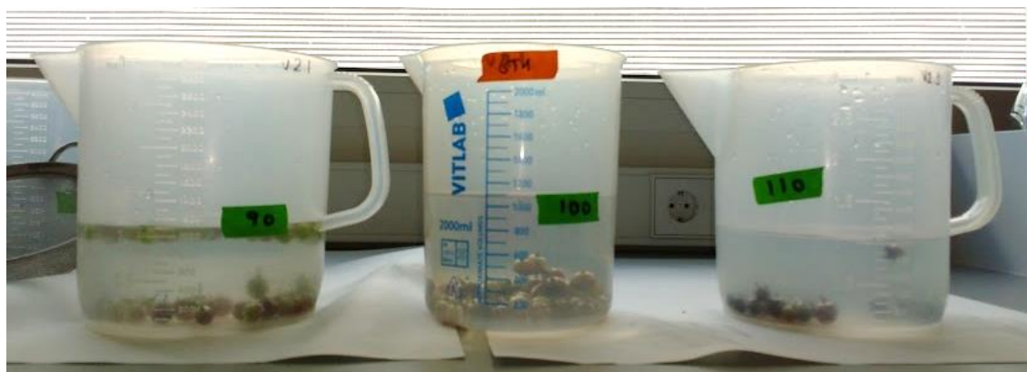
Figura 3.13. Selección de uvas en base a densidad. En la imagen se muestra la distribución las uvas en soluciones de tres concentraciones distintas en función de su flotabilidad. En este caso la densidad de la mayoría de las bayas se encuentra entre 100 y 110 g/l.
