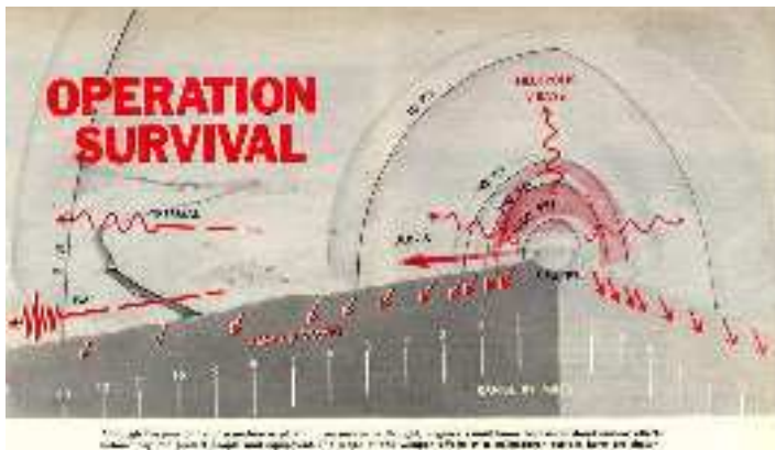
Figura 5.70: Efectos de la explosión nuclear de una bomba de 20 megatones. Las esferas concéntricas representan la sobrepresión causada en función de la distancia al punto de detonación. (Foss, 1969, p. 41)
