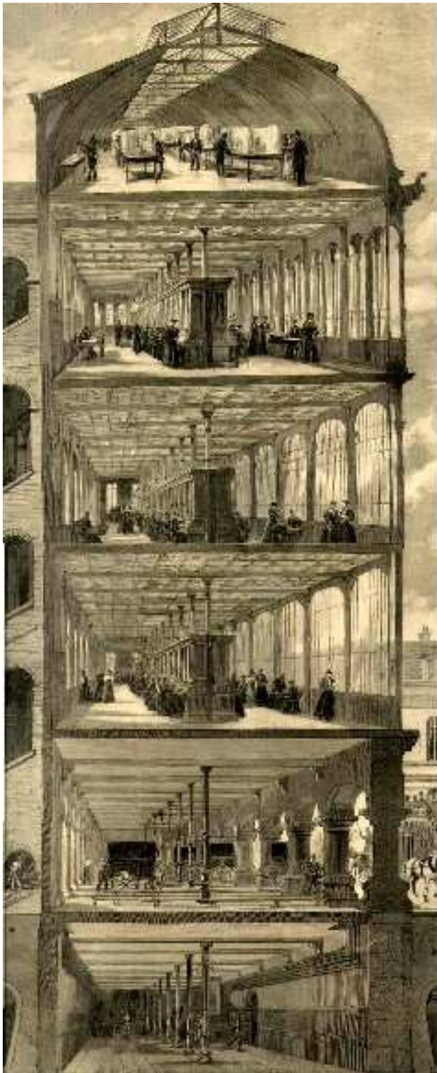
Figura 3.150: Izquierda, corte del cuerpo principal de la central Gutenberg , de París, de Jean Marie Boussard, según un grabado de Le Journal Illustré del 3 de septiembre de 1893. El cableado llegaba por el sótano, situado al mismo nivel que las cloacas. La planta baja era un pasaje de servicio hacia el resto del edificio. En los tres pisos se observa la gran superficie acristalada que facilitaba el trabajo de las operadoras. A la derecha, dos fotografías del interior a principios del siglo XX y una actual. Todas las imágenes son de la colección de Jean Godí, excepto la actual, publicada en 20minutes.fr.
