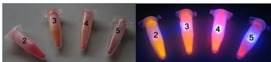
Figura I.37. Fotografía de las muestras sólidas de [\text{Au}_2\text{Ag}_2(o\text{-C}_6\text{F}_4\text{I})_4]_2 (2) expuestas a vapores de acetona (3), THF (4) y acetonitrilo (5) a la luz visible (izda) o ultravioleta (dcha).
