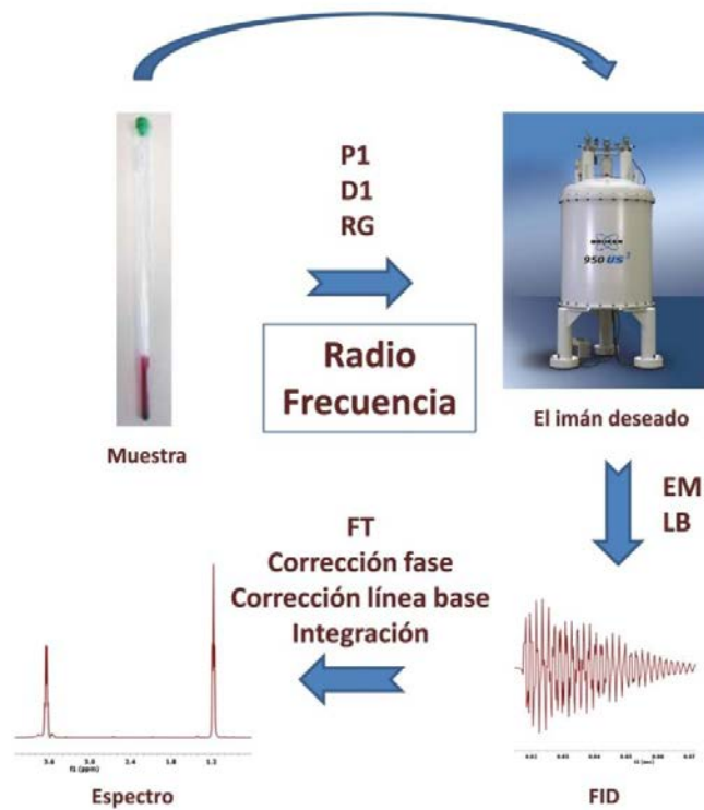
Figura 3.8. Esquema de adquisición y procesado de un espectro con los parámetros más importantes especificados para cada paso.
