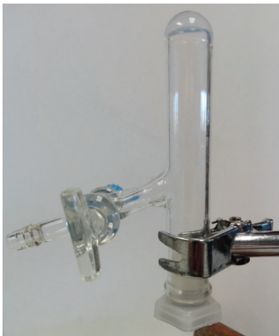
Figura 1.35. Hidrometalogel de 2 obtenido por concentración a vacío durante 6 h de una disolución diluida en un matraz Schlenk, girado para mostrar su resistencia a la inversión.
