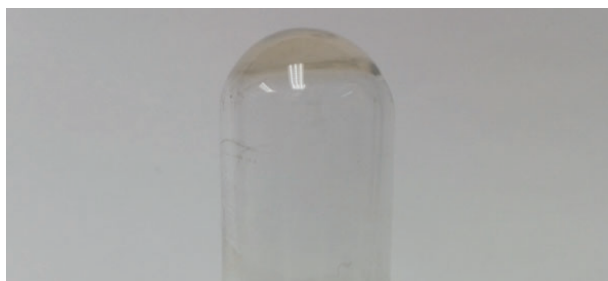
Figura 2.26. Hidrometalogel de 10 obtenido por concentración a vacío en matraz Schlenk de una disolución diluida, girado para mostrar su resistencia a la inversión.
