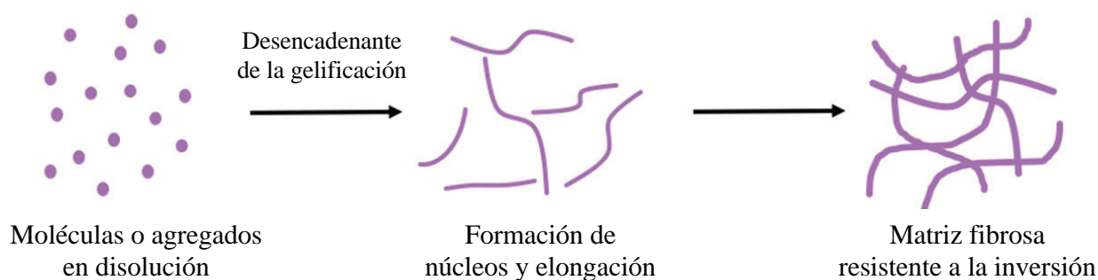
Figura I.3. Etapas secuenciales en la formación de un gel (adaptado de la referencia 22).
