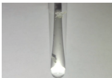
Figura 2.27. Monocristales de 10 ·2H 2 O obtenidos por cristalización espontánea en el seno de la matriz del hidrogel de 10 .
