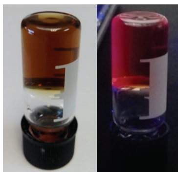
Figura 1.59. Fotografías del hidrometalogel de composición 50 mg·mL -1 1 + 50 mg·mL -1 5 bajo luz ambiental (izquierda) y UV de 365 nm (derecha), girado para mostrar su resistencia a la inversión. Nótese el color ámbar del gel y su emisión roja.
