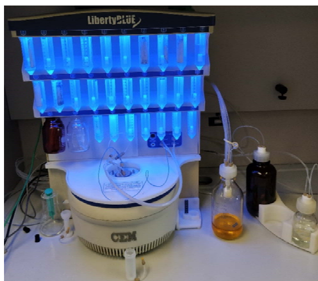
Figura 5.1. Sintetizador de péptidos automático CEM Liberty Blue.
