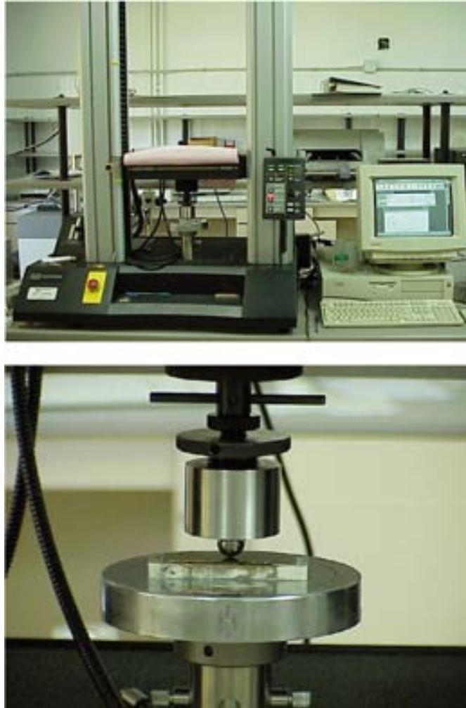
Figura 4.2: Máquina de ensayos Instron 5565 (imagen superior) y detalle de un ensayo de indentación Hertz con una esfera de 12.7 cm de radio (imagen inferior).
