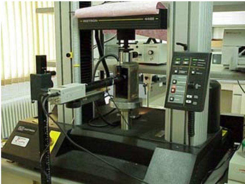
Figura 4.4: Esquema del montaje y fotografía del sistema de observación in situ.
