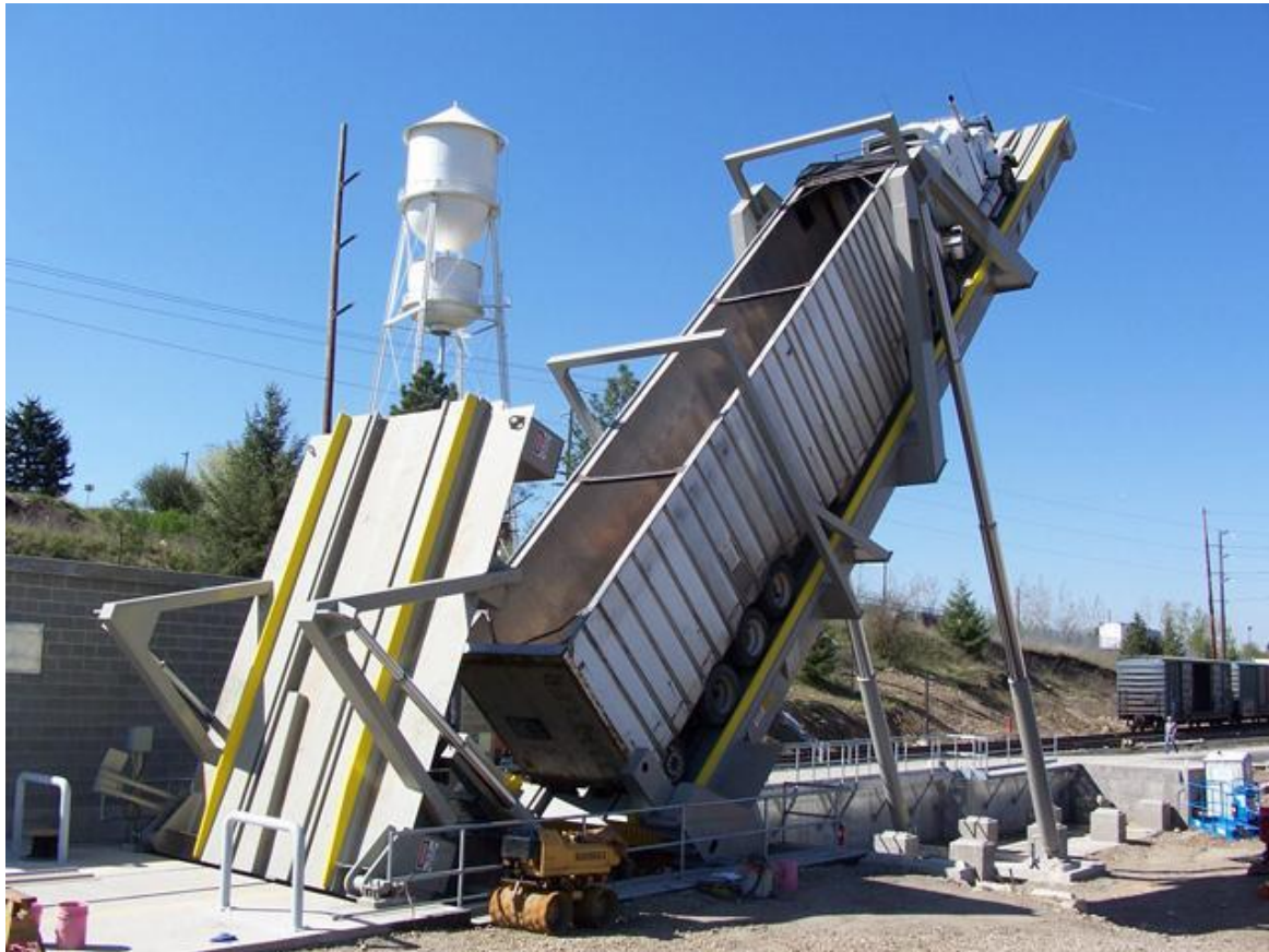
Figura 11. Descarga de contenedor de biomasa en plataforma hidráulica [44]
