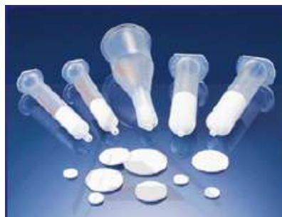
Figura I.14. Cartuchos y discos usados en SPE (fuente: www.genopore.com )
