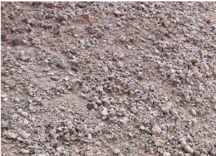
Imagen 3.20 Imagen de los áridos reciclados usados para los ensayos
