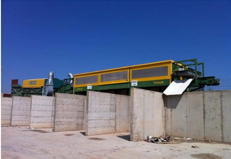
Imagen 3.10 Planta fija de extracción con fosos para los materiales extraídos.
