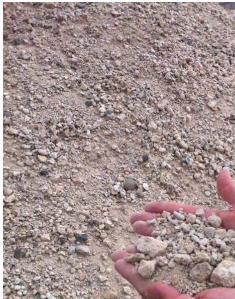
Imagen 3.22 Árido reciclado usado para los ensayos
