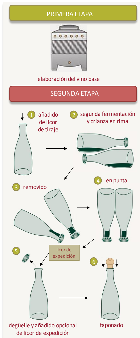
FIGURA 4. Esquema del proceso de elaboración de los vinos espumoso mediante el método tradicional. Adaptado de (10)
