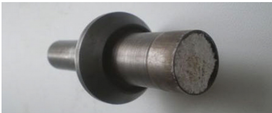
Figura 2.2: Adherencia del aditivo al punzón
