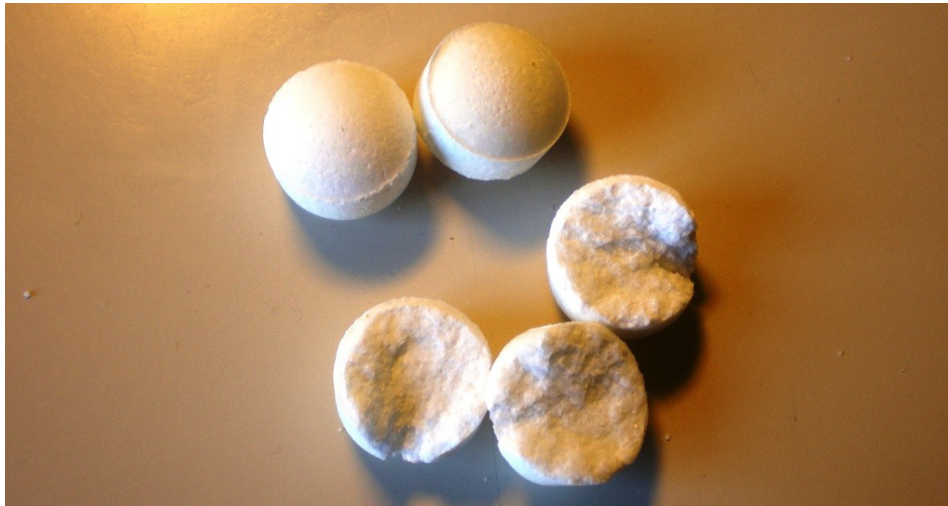
Figura 2.3: Fractura por adherencia al casquete superior del punzón
