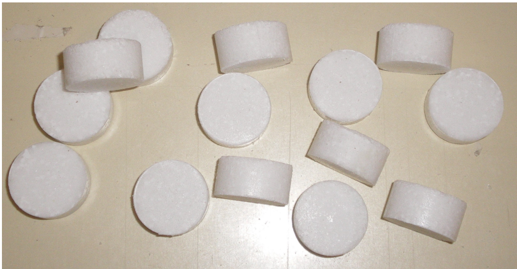
Figura 5.4: Comprimidos de 22 mm de diámetro obtenidos en la prensa
