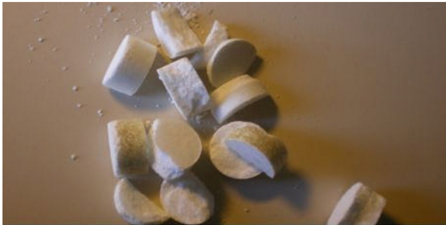
Figura 2.1: Fractura por baja compactación
