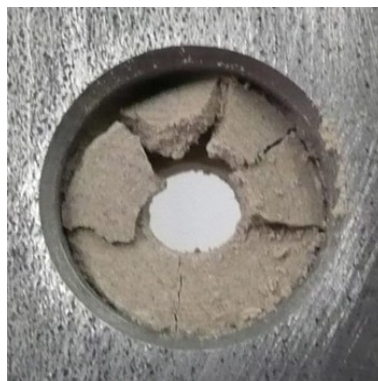
Figura 2.9: Comprimido después del ensayo de resistencia
