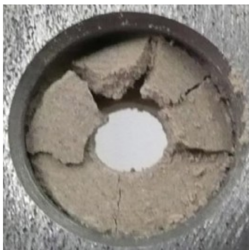
Figura 5.103: Test de penetración de una pastilla (García, 2010)
