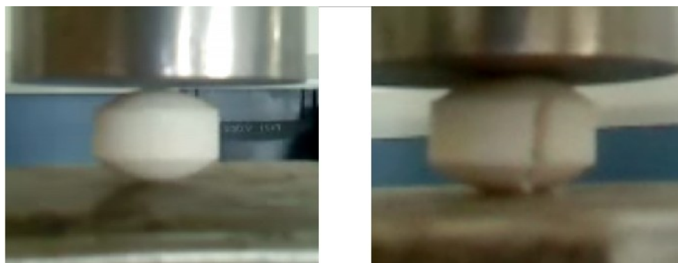
Figura 4.3: Test de compresión diametral. Inicio (izda.) y aparición de grieta (dcha.)
