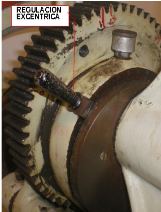
Figura 3.8: Regulación punzón superior
