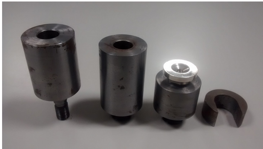
Figura 3.31: Piezas diseñadas para adaptar la prensa de laboratorio
