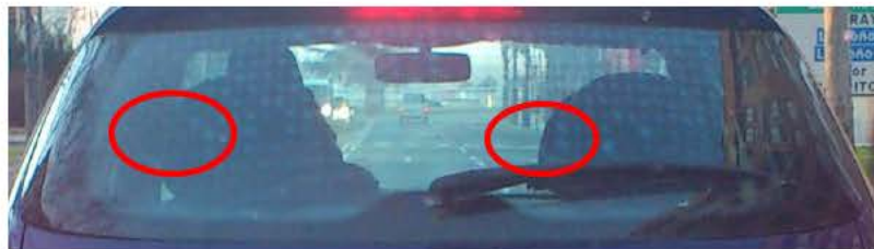
Figura 15.5.1. Luneta trasera vehículo comercial de 2004. Se aprecia una correcta distribución de la soplante. Esto indica que es una máquina a medida de la pieza. La falta de lagunos puntos indica problemas puntuales en la máquina. Aunque no son de importancia, un control de los mismos asegura una producción según los parámetros de diseño.
