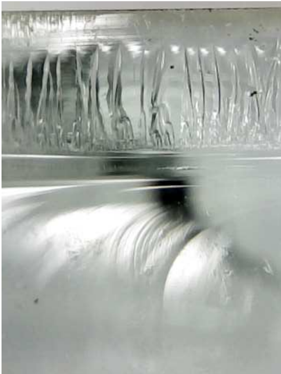
Figura 11.2.5. Marcas tipo 2 Twist hackle. Un caso frecuente de este tipo de rotura se encuentra en los vidrios templados. Es debido a que en esta zona la tensión interna cambia a compresión, viéndose alterado el estado tensional del vidrio. La rotura, entonces, se propaga perpendicular a la superficie a la vez que avanza a lo largo del vidrio, generando una rotura diferente al resto de la sección, donde solamente avanza en dirección de propagación a lo largo del vidrio.
