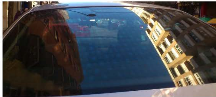
Figura 15.5.4. Luneta trasera de un vehículo de alta gama comercial de 2001. La distribución es homogénea y en la posición y uniforme en la tensión. Aunque es un modelo de serie baja de unidades, se aprecia la fabricación de una máquina particular para su fabricación.
