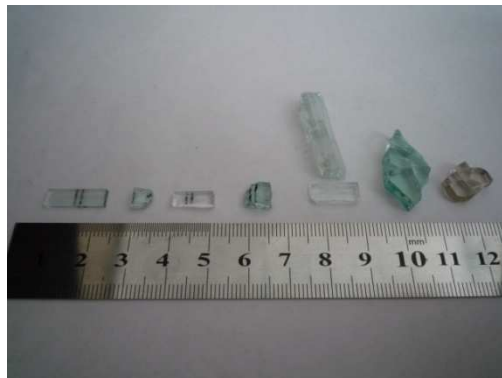
Figura 14.3.1. Comparativa de diferentes fragmentos. La selección del fragmento adecuado es fundamental para una correcta inspección.
