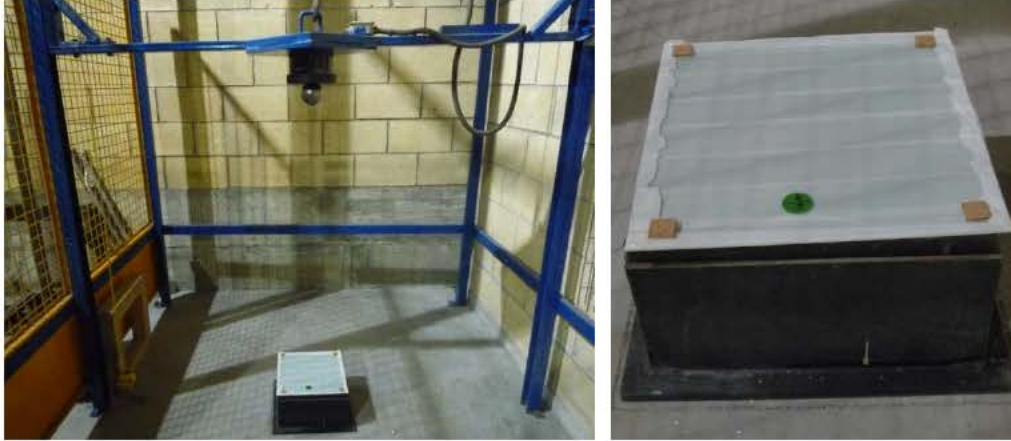
Figura 7.3.3: Ensayo de impacto. En la imagen de la izquierda se aprecia la configuración básica del ensayo: En vidrio es apoyado en un contorno rígido y sobre él se coloca una bola de acero que se dejará caer a diferentes alturas. La imagen de la derecha muestra el detalle de la colocación del vidrio en el soporte. Cortesía Starglass S.A.
