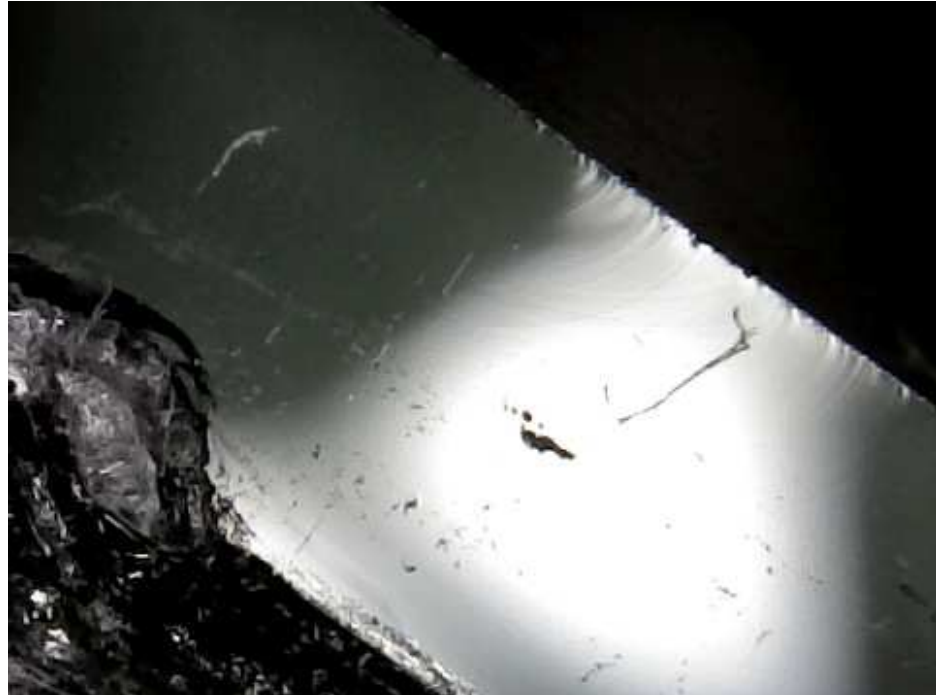
Figura 11.2.7. Tipo 4a: Primary Wallner line. La onda es claramente visible. Cuando son aisladas son causa generalmente de irregularidades de la superficie).
