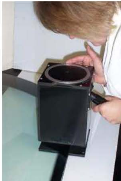
Figura 6.3.5: Polariscopio S-69 de Sharples Stress. Permite la medición de tensiones absolutas en el vidrio, para zonas con serigrafía. Se basa en el mismo concepto pero en lugar de aprovechar la luz transmitida a través del vidrio, utiliza la luz reflejada en la cara opuesta a la serigrafía.
