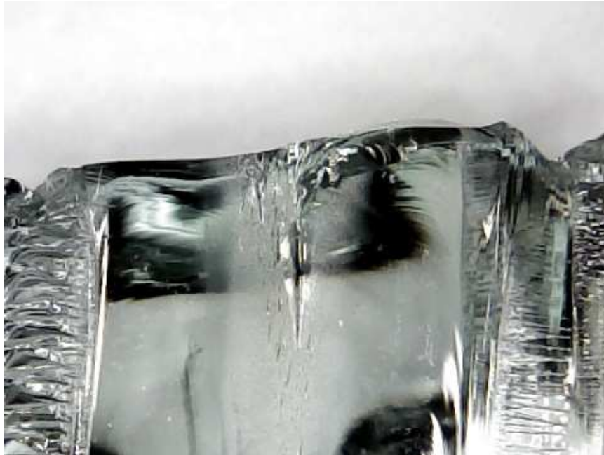
Figura 11.3.5. Imagen de un fragmento irregular, cuyos lados no son paralelos, presentando ángulo debido a la bifurcación de la grieta. Las zonas de mirror, mist y hackle no son tan evidentes, y en muchos casos no se llega a la velocidad máxima dentro del fragmento, por lo que no se presentan. En este caso se observan con claridad las marcas de rotura en la zona de compresión, presentando estrías twist hackle evidentes en ambos lados.
