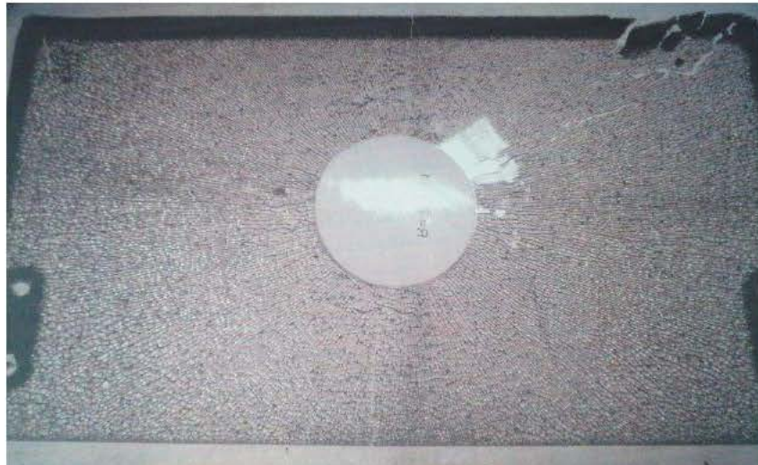
Figura 10.2.2: Ensayo de fragmentación en un vidrio templado. Fotografía de análisis de producción (Cortesía Starglass S.A.)
