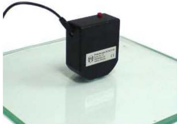
Figura 6.3.2: Scalp - 04 de Glassstress mide la distribución de tensiones completa en cualquier sección del vidrio.
