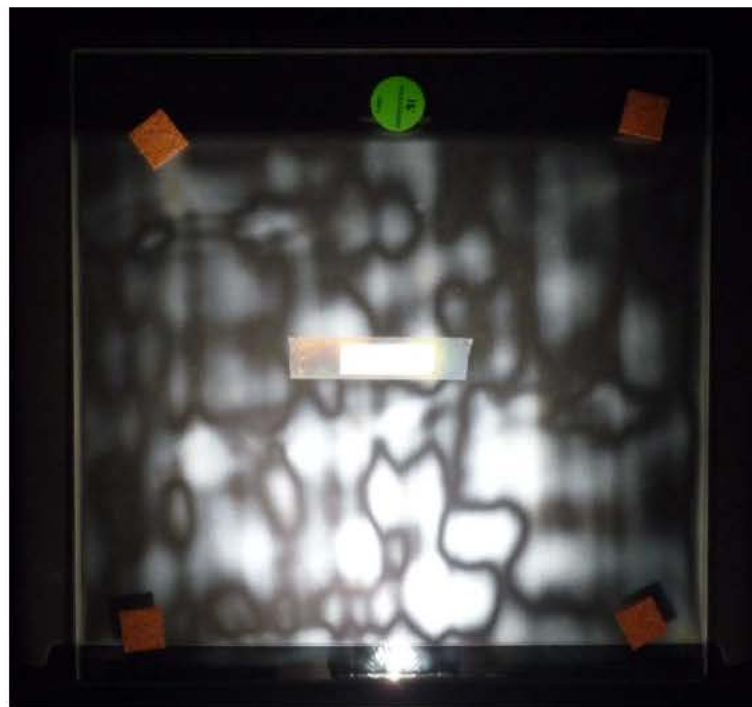
Figura 9.3.1. Distribución de tensiones en la superficie del vidrio. Las líneas negras indican los puntos de tensión cero, donde la luz no se ve polarizada y se anula. Sin embargo en el resto de zonas la luz atraviesa, indicando un cambio en el plano de polarización. Se observa que el patrón es irregular, lo que denota una falta de uniformidad en la acción del aire sobre el vidrio en el momento del templado.
