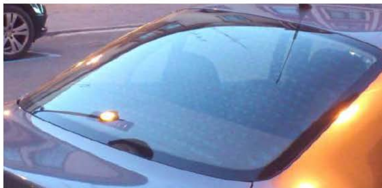
Figura 15.5.5. Al igual que la figura 13.5.4, la luneta es de un vehículo de alta gama, pero más moderno, de 2013. Las marcas, además de homogeneidad y uniformidad, presentan un patrón de diferentes geometrías (círculos y rectángulos). Esto indica una soplante con una geometría más moderna que asegura un correcto equilibrado del vidrio.
