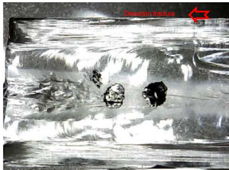
Figura 11.3.4. La imagen representa un fragmento similar a la figura 9.3.3. En este caso la rotura parte del lado derecho y se dirige hacia el lado izquierdo, como se puede deducir de la observación de las líneas de Wallner y la zona hackle, muy evidente en la zona central del lado izquierdo..
