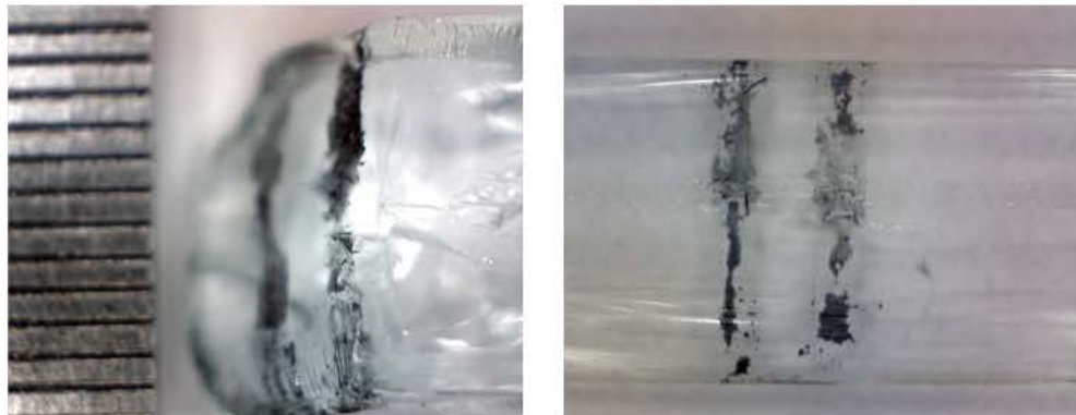
Figura 14.3.3. Marcado de la sección del fragmento. La identificación del punto de medida es fundamental, ya que diferentes puntos darán diferentes resultados, como ya se demostró en el capítulo 10..
