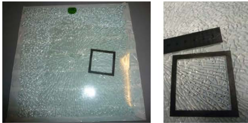
Figura 7.3.1: Ensayo de fragmentación en probeta. La imagen de la izquierda muestra el tamaño de la probeta, un patrón de rotura y la selección de la zona de mínima cantidad de fragmentos. La imagen de la derecha muestra el recuento y la medida de la aguja más larga.
