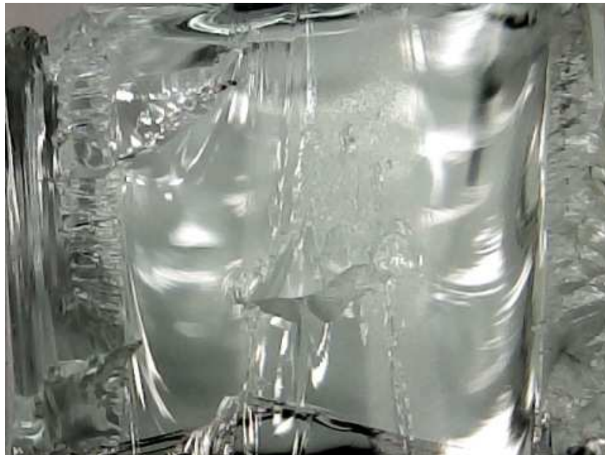
Figura 11.3.6. Los fragmentos muy irregulares presentan otros tipo de marcas debido a la unión de varias causas de la rotura, y comienzos de rotura simultáneos por dos zonas de lo que será posteriormente el fragmento. Se aprecia que el lado derecho de la imagen presenta el patrón esperado, mientras que el izquierdo tiene roturas por medio de la zona habitual de líneas Wallner.
