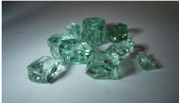
Figura 11.3.2. La geometría de los fragmentos es irregular, presentando caras no paralelas debido a la bifurcación de la grieta al propagarse.
