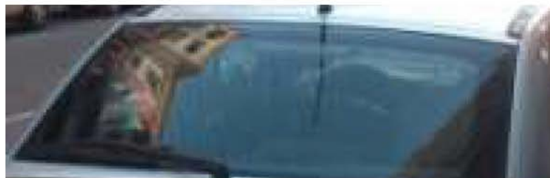
Figura 15.5.2. Luneta trasera vehículo comercial de 1996. Aunque la distribución es adecuada, la difusión de las marcas indica un soplado más alejado del vidrio, lo que podría indicar el uso de una soplante universal. Esto es frecuente en modelos cuya curvatura resulta sencilla.
