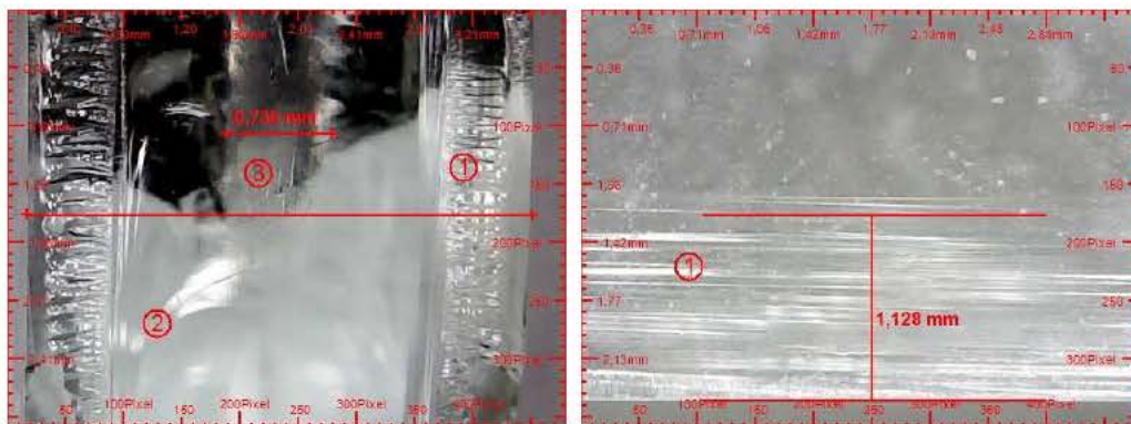
Figura 14.3.5. La medición precisa de las marcas de los fragmentos permite conocer las características de su rotura, y comparar con las mediciones de tensión.
