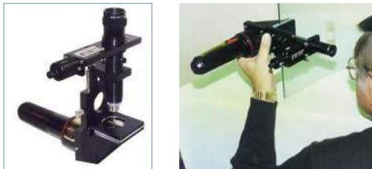
Figura 6.3.3: Polariscopio GES-100 Edge meter de Straioptics. Permite la medición de tensiones de borde para el análisis de vidrios laminados o templados.
