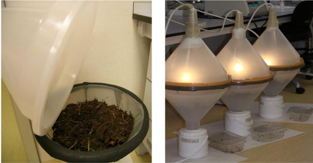
**Figura 19.** Embudos de Berlese-Tullgren empleados para la extracción de ácaros del suelo. Aportación original.
