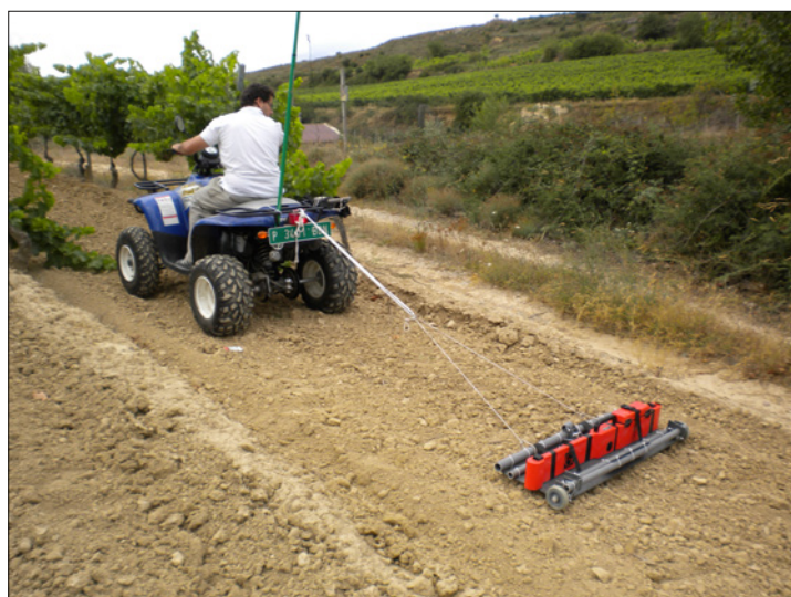
Figura 4.4. Sensor EM38 montado sobre trineo y arrastrado por un quad en el viñedo experimental.
