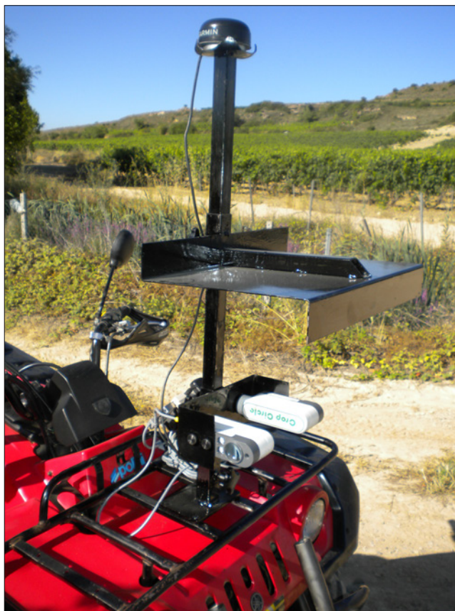
Figura 2.4. Sensores CropCircle™ montados sobre un quad en un viñedo de Rioja Alavesa.
