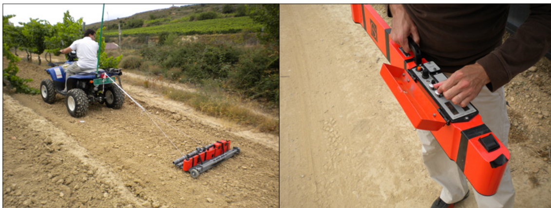
Figura 2.5. Sensor edáfico EM38 de conductividad eléctrica: calibración y uso sobre trineo plástico en un viñedo de Rioja Alavesa.
