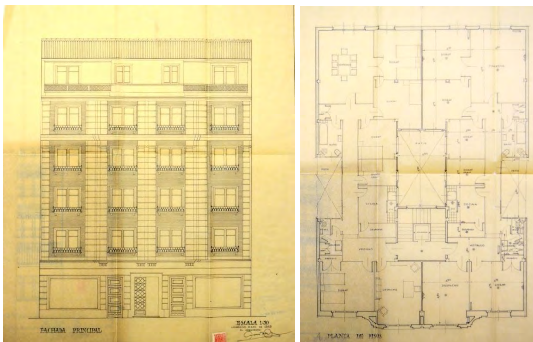
Fig. 89. Edificio de 10 viviendas, tiendas y almacenes, calle Calvo Sotelo 10, alzado original y planta tipo de viviendas, Logroño, A. del Valle, 1949 (AML PU 374/1949)
